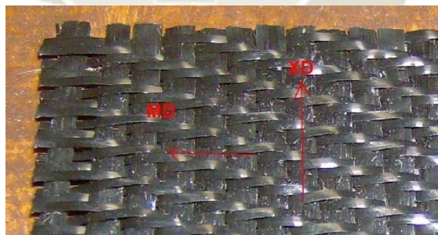
Gráfico 3-17 Geotextil tejido dirección de las fibras MD (machine direction) XD(cross dirección) Fuente: (Tellez, 2008)
