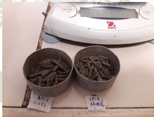
Foto N°09 preparación de rollitos para determinación del límite plástico.
