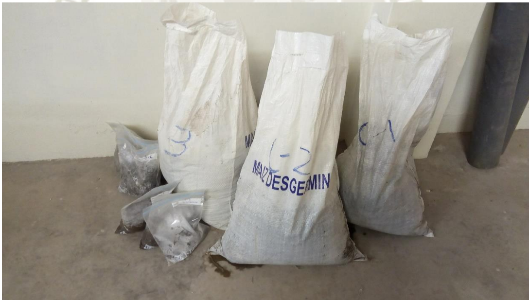
Foto N°04 Muestra alterada e inalterada para los estudios de laboratorio
