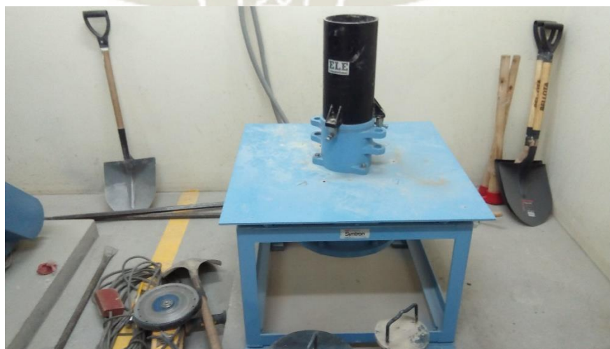
Foto N°07 Mesa vibratoria para Densidad máxima. Fuente: Elaboración Propia
