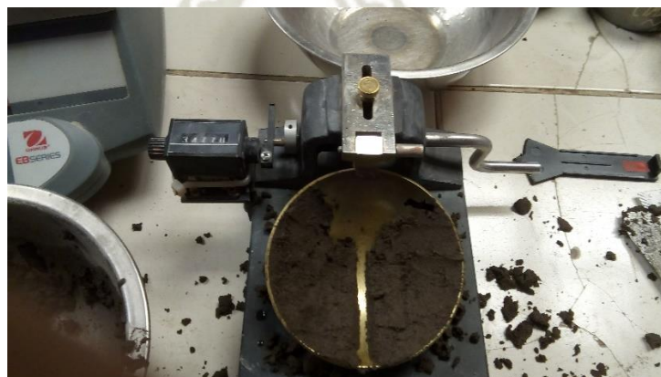
Foto N°10 Cuchara de Casa Grande Determinación limite líquido.
