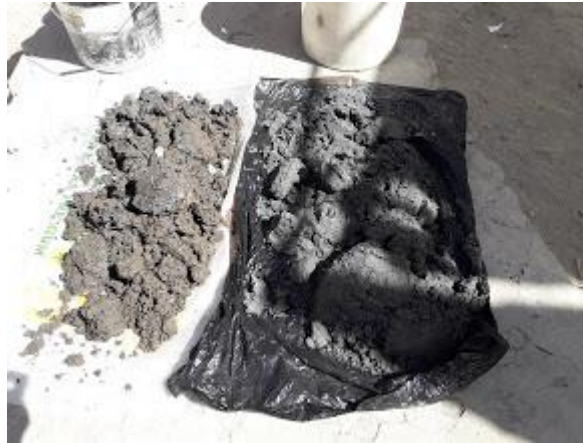
Foto N°05 Secado de las muestras saturadas al aire libre. Fuente: Elaboración Propia
