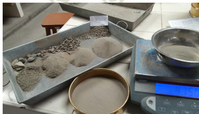
Foto N°13 Análisis granulométrico por tamizado. Fuente: Elaboración Propia
