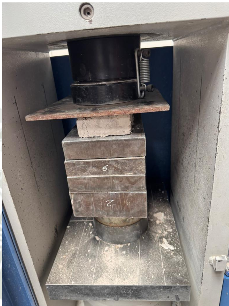
Fotografía No. 20. Ensayo de compresión axial en adoquín peatonal reciclado
