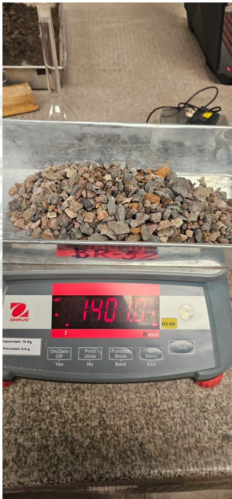
Fotografía No. 4. Pesado de árido grueso para diseño de mezcla con adición de materiales reciclados
