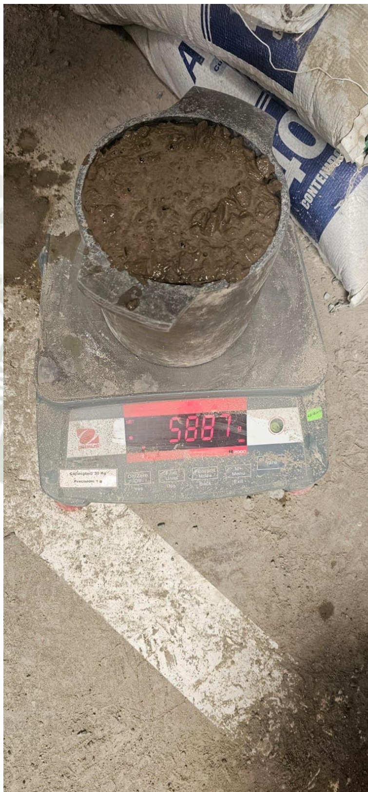
Fotografía No. 11. Pesado de muestra de concreto fresco en recipiente metálico
