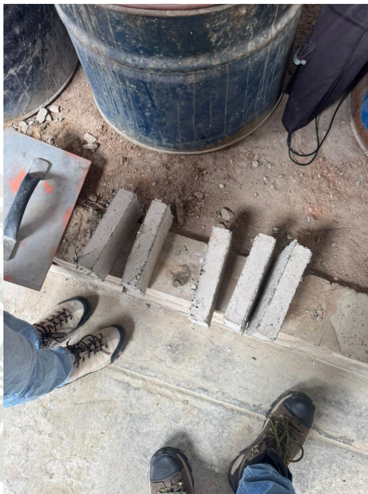
Fotografía No. 21. Adoquines peatonales con adiciones recicladas dispuestos para los ensayos
