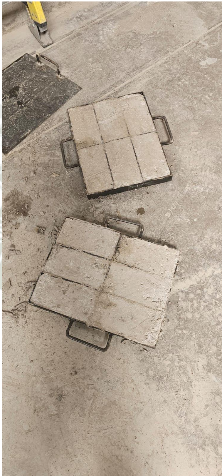
Fotografía No. 18. Moldes metálicos con adoquines peatonales recién vaciados
