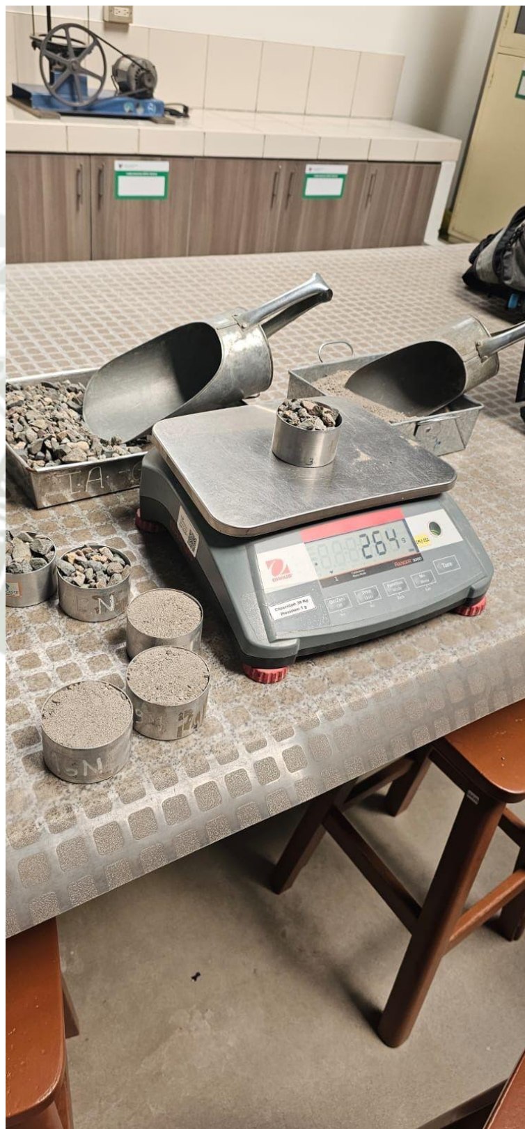
Fotografía No. 3. Preparación y pesado de áridos y adiciones recicladas para diseño de mezcla
