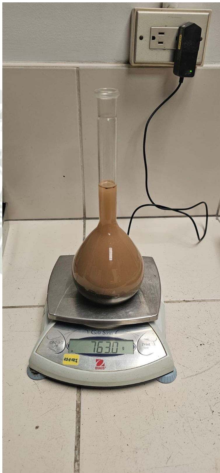
Fotografía No. 5. Medición de masa de muestra líquida con partículas finas en balanza electrónica
