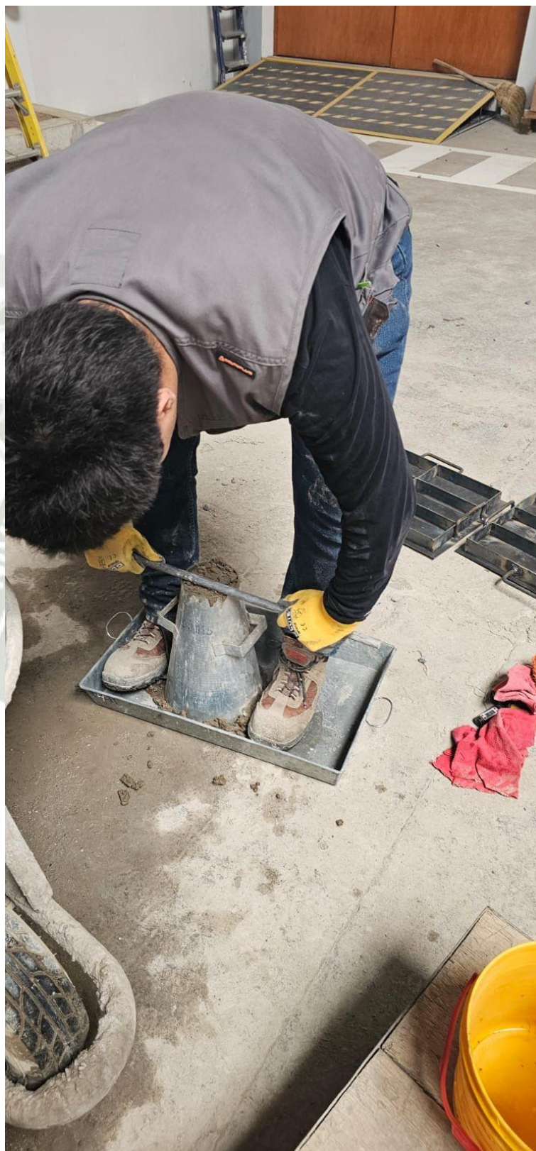
Fotografía No. 15. Llenado del molde troncocónico en el ensayo de asentamiento del concreto
