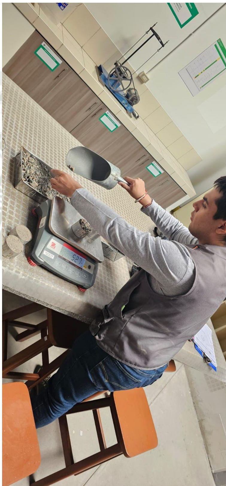
Fotografía No. 1. Pesado de áridos gruesos para la elaboración de adoquines con adición de caucho reciclado y PET
