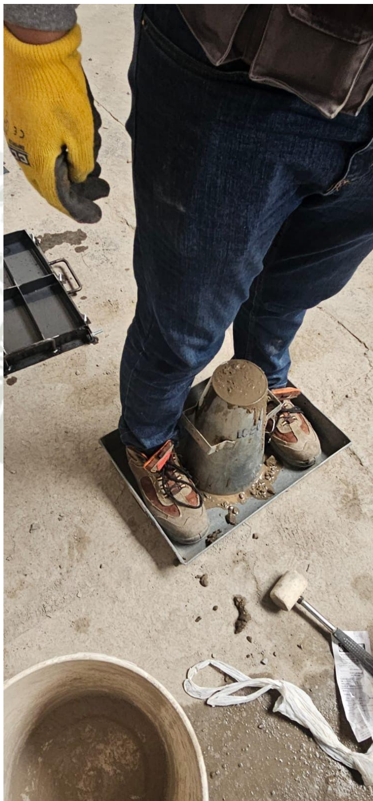
Fotografía No. 6. Ensayo de asentamiento con mezcla de concreto modificada con caucho reciclado y PET
