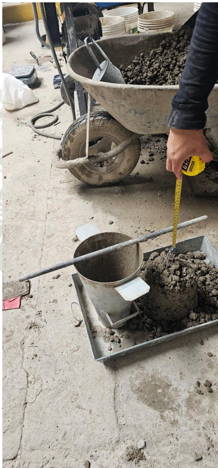
Fotografía No. 17. Medición de asentamiento del concreto con adiciones recicladas mediante ensayo de revenimiento
