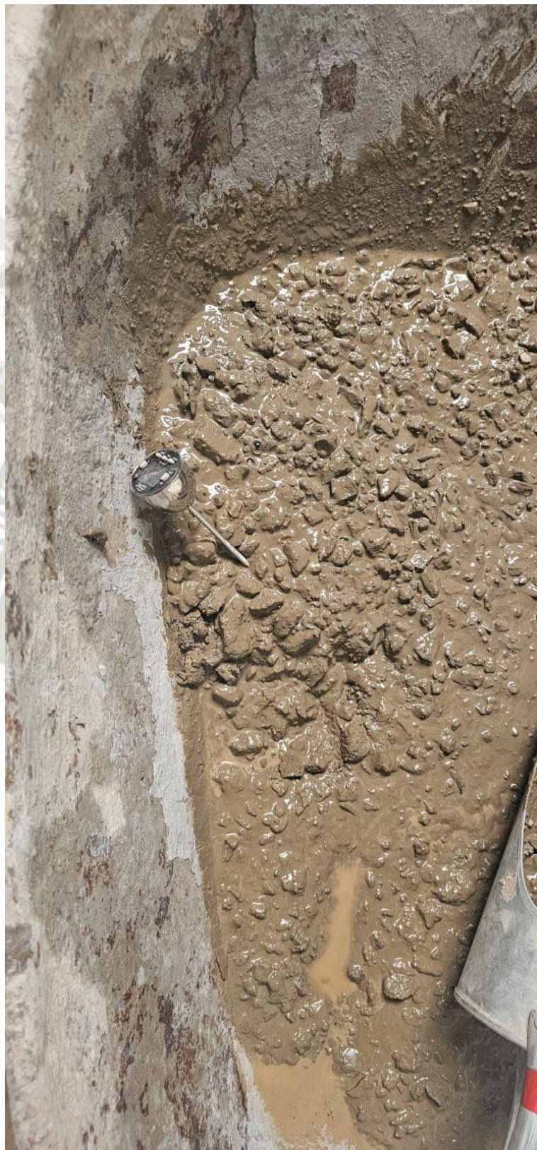
Fotografía No. 7. Control de temperatura en mezcla fresca de concreto con adición de caucho reciclado y PET
