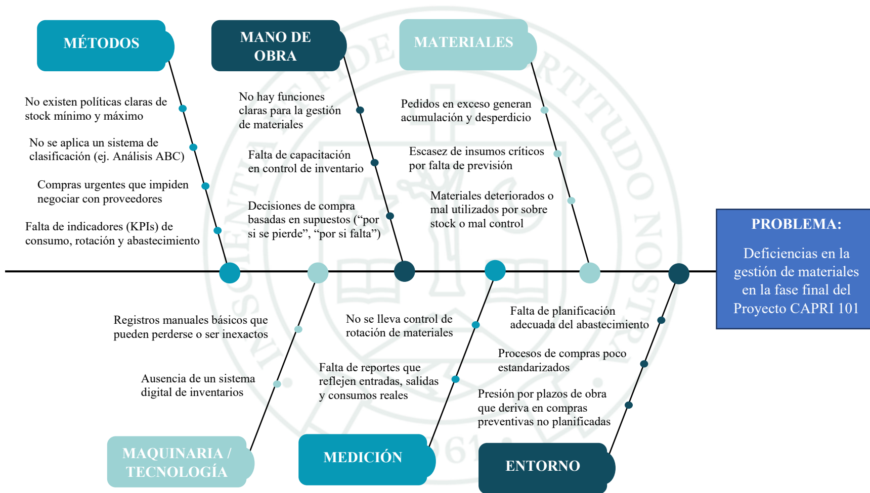
Diagrama Ishikawa – Deficiencias en la gestión de materiales en la fase final del proyecto CAPRI 101
