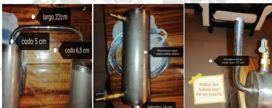
Figura N° 32. Diseño y construcción con especificaciones técnicas: Sistema de enfriamiento (derecha) Sistema de conducción de vapores (centro) salida de aceite e hidrolato (izquierda)
