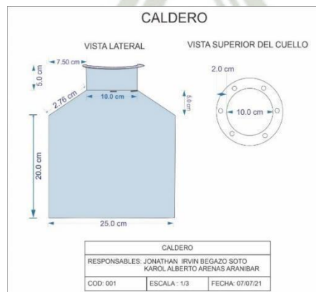
Figura N° 4. Diseño y especificaciones técnicas a escala 1/3 de Caldero
