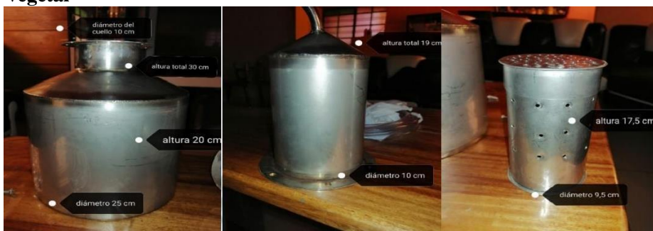
Figura N° 32. Diseño y construcción con especificaciones técnicas: Sistema de enfriamiento (derecha) Sistema de conducción de vapores (centro) salida de aceite e hidrolato (izquierda)
