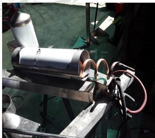
Figura N° 8. Construcción y armado del prototipo de destilador
