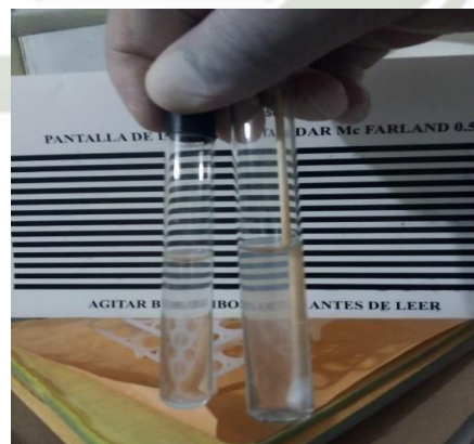
Figura N° 28. Prueba de Comparación de los inóculos con escala de Mac Farland 0.5M.
