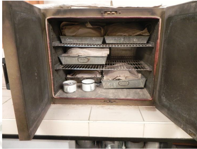
Figura N° 11: Material extraído de las parcelas para el cálculo de control biomasa colocado en una estufa.
