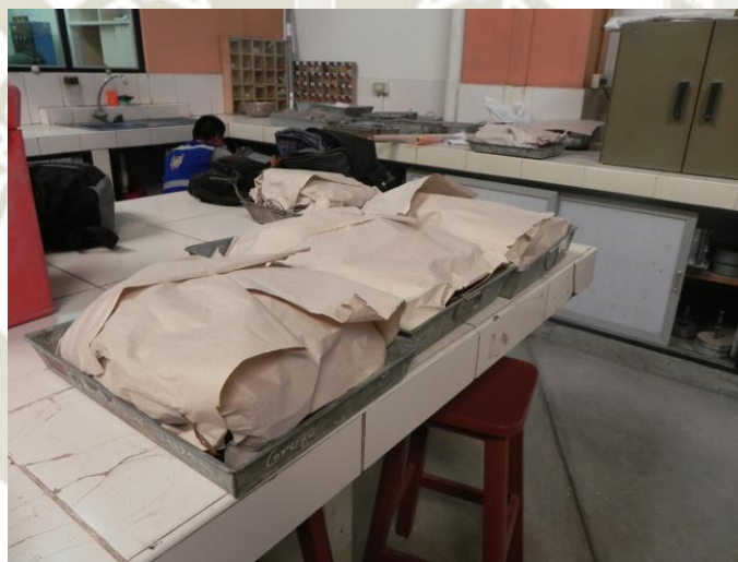
Imagen 4: Muestras empaquetadas para la estufa
