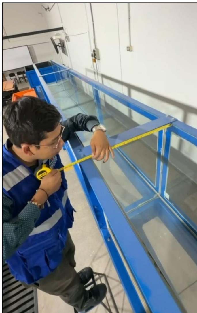
Medición del ancho del canal de ensayo, registro de participación en laboratorio
