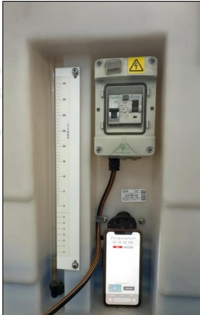
Comprobación de caudal del banco hidráulico por el método volumétrico
