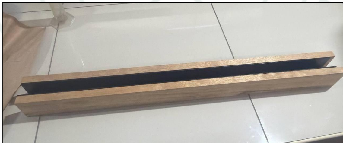
Canal de prueba para la obtención de rugosidad del material "Vinifan"
