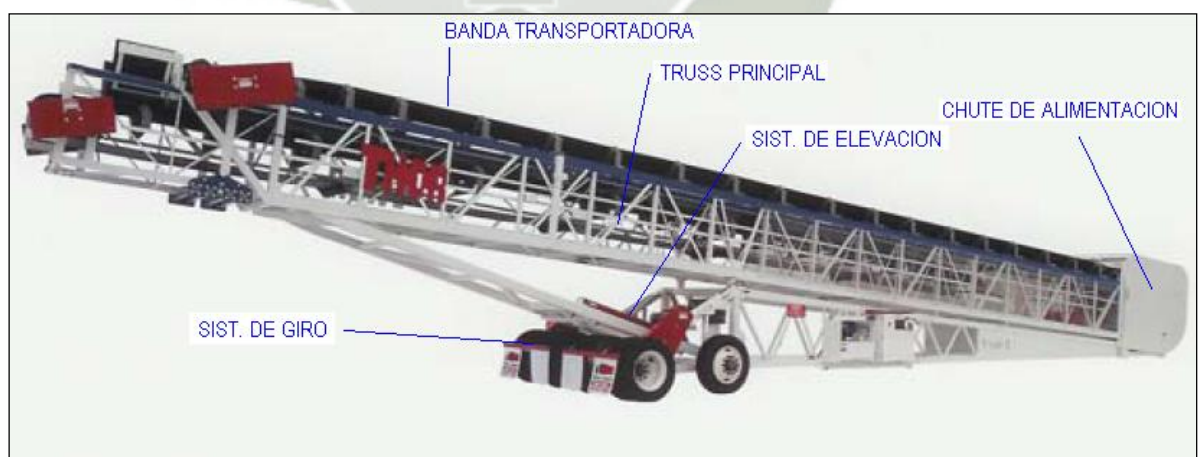
Figura 2.12 Partes principales de apiladores radiales
