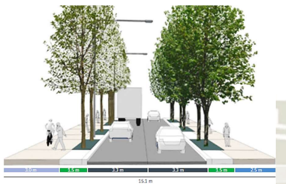
Ilustración 15: Sección A Road South 15.1m
