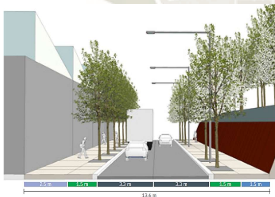
Ilustración 17: Sección B, Road West 13.6m
