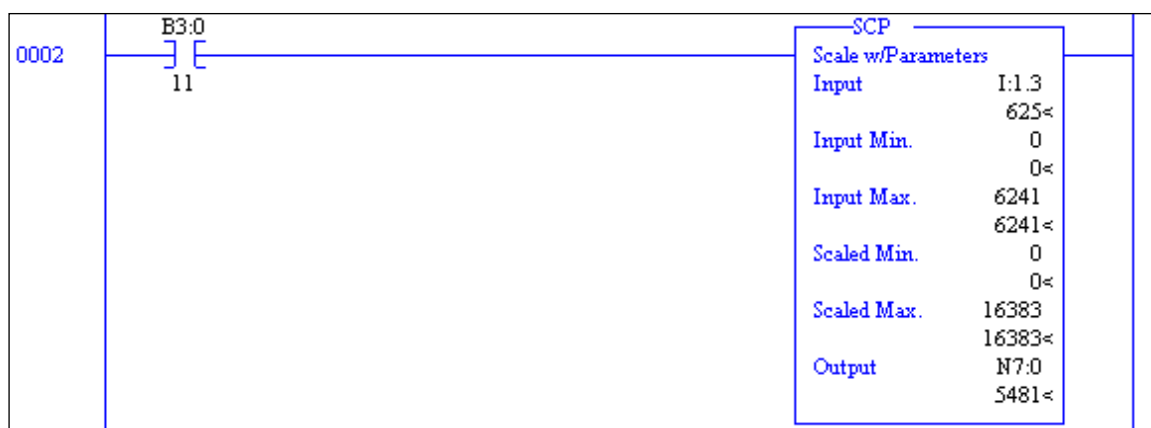
Figura 5. 67: Programa ladder de escalamiento para lazo de temperatura. Fuente: Programa RSLogix 500.
