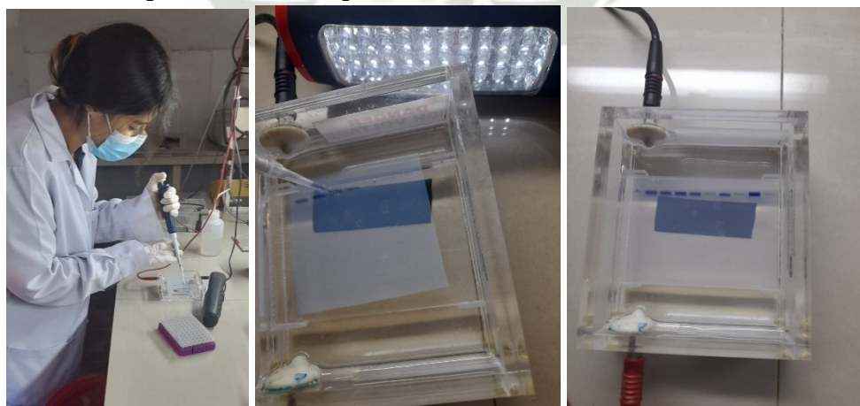
Figura 51, 52 y 53. Cámara de Electroforesis con el gel al 1.5% cubierto de TAE en la que se llenan los pozos con los resultados de la PCR.
