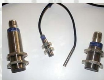
Figura 26: Características sensor inductivo
