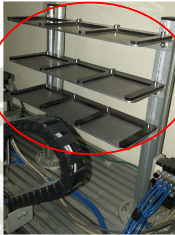
Figura 33: Acoplamiento de planchas de aluminio
