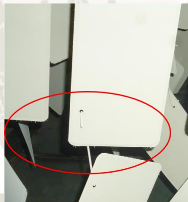
Figura 21: Presencia de pelusas.
