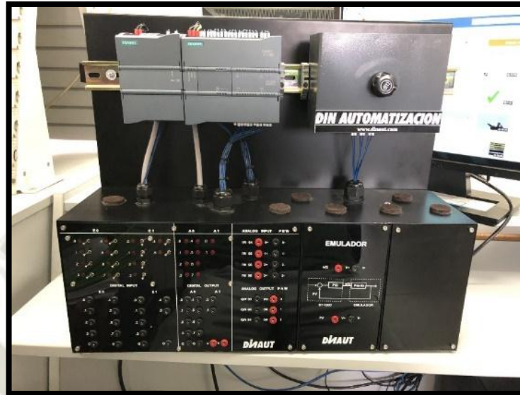
Figura 25. Módulo de entrenamiento S7-1200 de DINAUT Fuente: Elaboración propia
