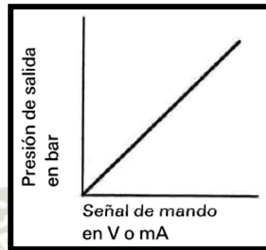
Figura 10. Curva Presión de Salida vs Señal de mando Fuente: Serrano Nicolás (2009)
