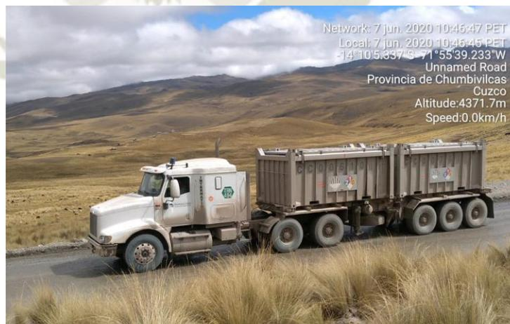
*Ilustración 15: Camión de transporte de concentrado y contenedores ISO.
