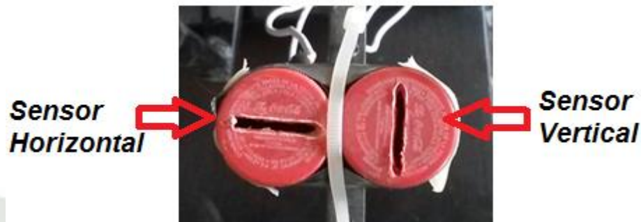
Fig. 3. 13 Sensores de Luz para Seguidor Solar (Fuente: Elaboración Propia)
