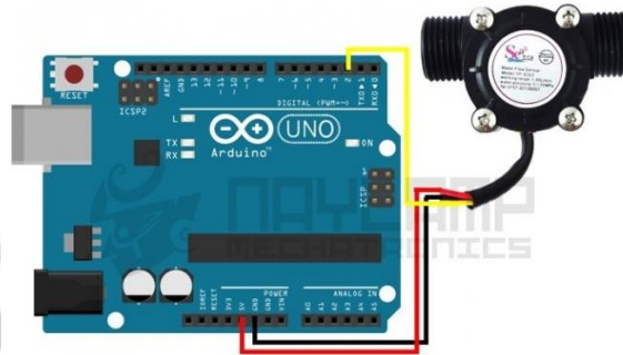
Fig. 3. 23 Conexión con el Arduino (Fuente: www.naylampmechatronics.com )
