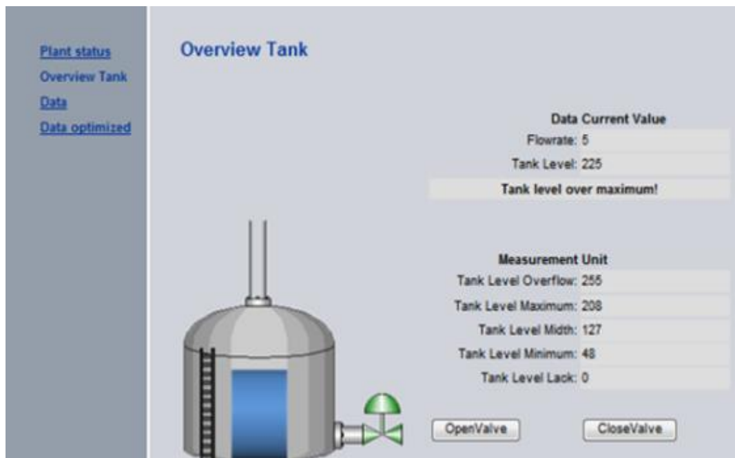
Fig. 2. 21 Visualización de un SCADA a través del Web Server (Fuente: support.industry.siemens.com)
