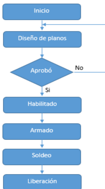
Figura 6: Proceso de Fabricación de Estructuras Metálicas
