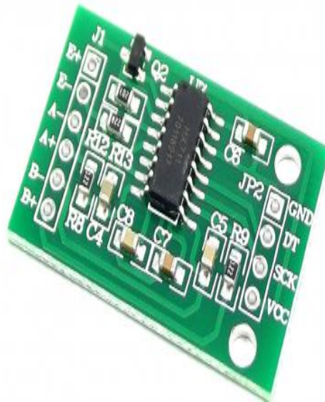
Imagen 4. Transmisor de celda HX711
