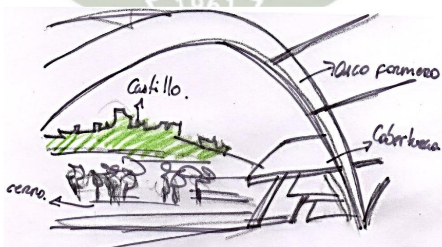
Figura N° 26: Estructura de arcos de madera
