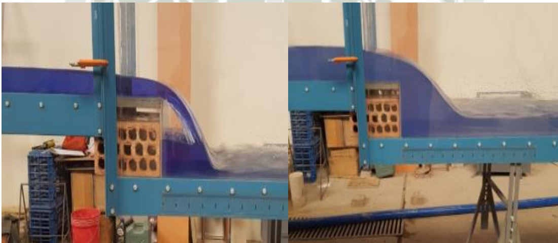
Figura 4.7-. Apreciación de los perfiles de la caída vertical no ahogada (izquierda), y cuando esta se encuentra ahogada (derecha) para la altura \Delta Z=0.200 m.
