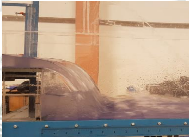
Figura 4.9-. Apreciación del perfil la caída vertical NO VENTILADA para la altura \Delta Z=0.300 m.
