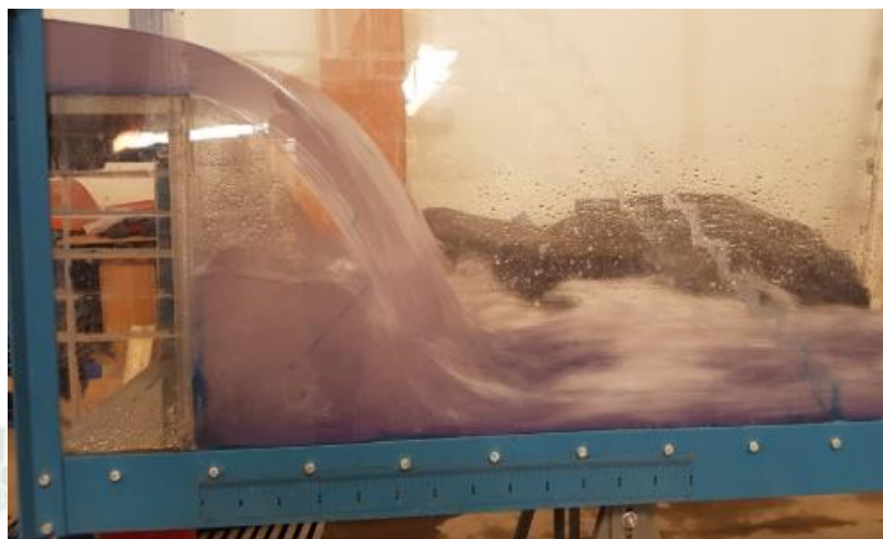
Figura 4.12-. Apreciación del perfil la caída vertical NO VENTILADA para la altura \Delta Z = 0.450 m.
