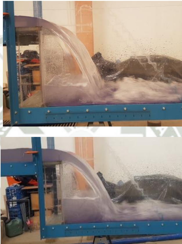
Figura 4.18-. Apreciación del perfil la caída vertical VENTILADA para la altura \Delta Z = 0.450 m. Q = 25.993 l/seg (arriba), 32.343 l/seg (abajo).
