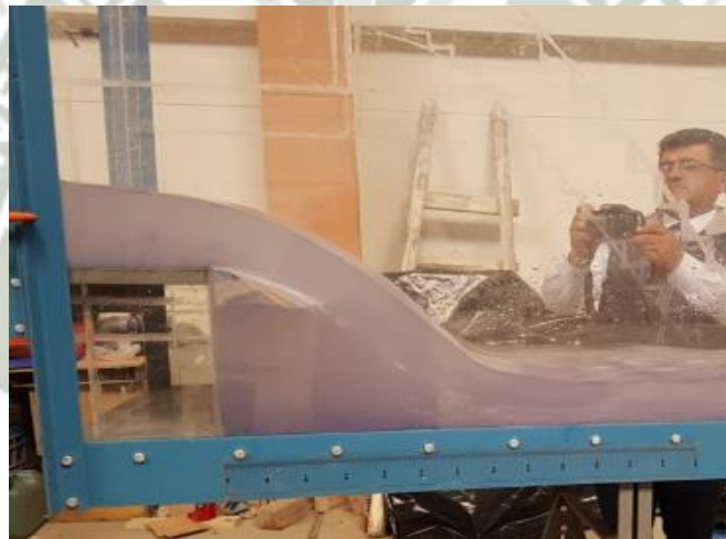
Figura 4.8-. Apreciación del perfil la caída vertical NO VENTILADA para la altura \Delta Z=0.250 m.
