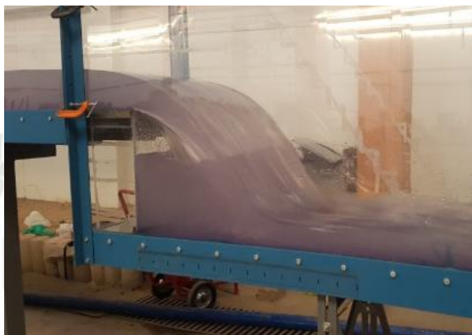
Figura 4.14-. Apreciación del perfil la caída vertical VENTILADA para la altura \Delta Z=0.300 m., Q= 61.809 l/seg.
