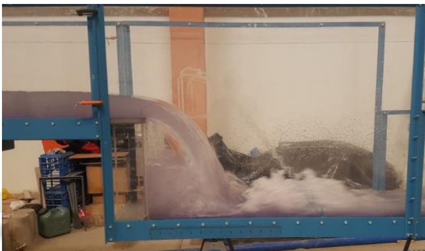
Figura 4.13--. Apreciación del perfil la caída vertical NO VENTILADA para la altura \Delta Z=0.500 m.
