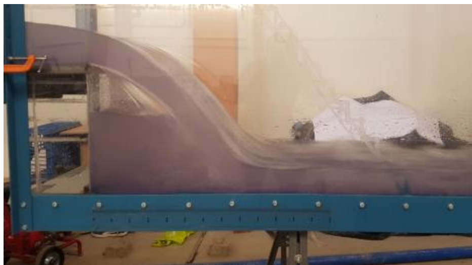
Figura 4.15-. Apreciación del perfil la caída vertical VENTILADA para la altura \Delta Z=0.350 m. Q= 65.095 l/seg.
