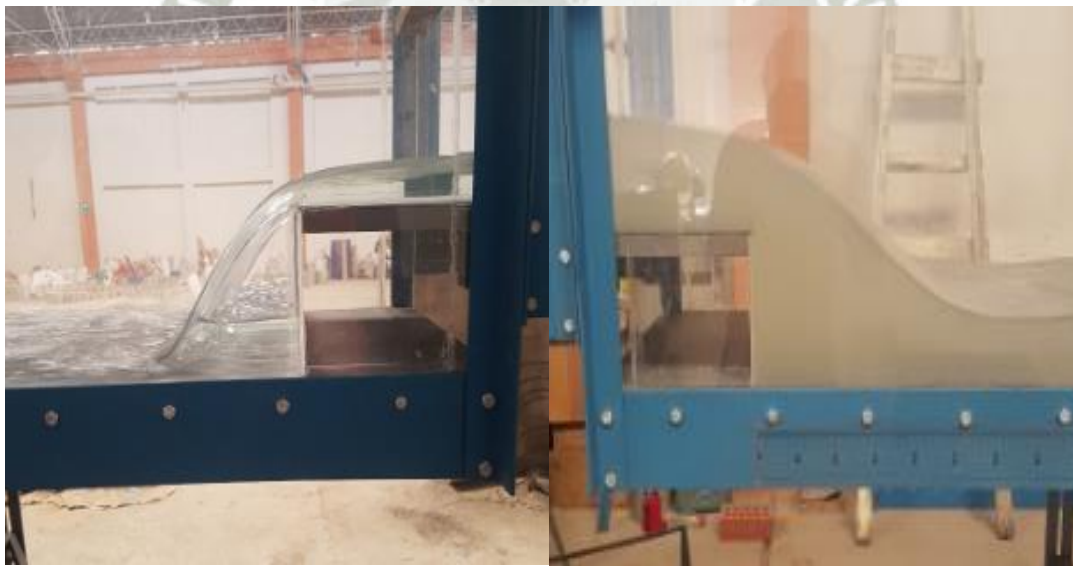
Figura 4.6.- Apreciación de los perfiles de la caída vertical no ahogada (izquierda), y cuando esta se encuentra ahogada (derecha) para la altura \Delta Z=0.149\text{m} .
