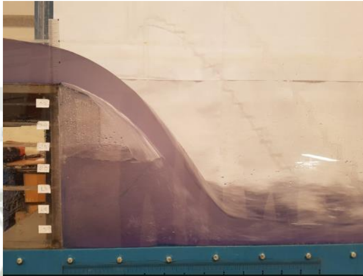
Figura 4.16-.Apreciación del perfil la caída vertical VENTILADA para la altura \Delta Z=0.400 m. Q= 62.788 l/seg.
