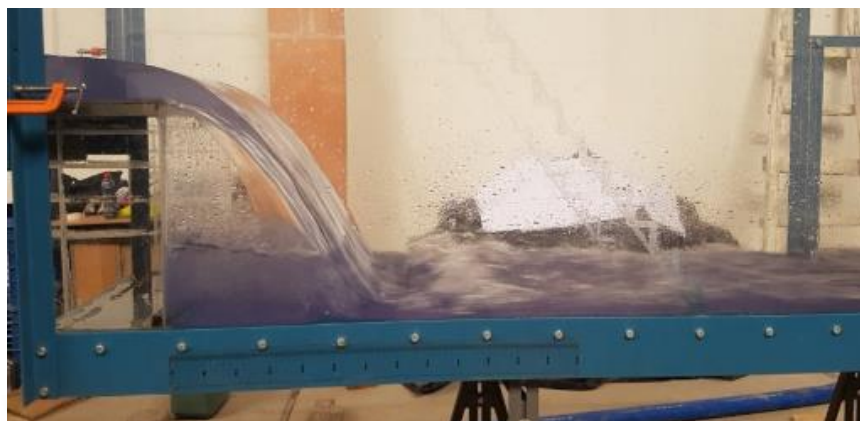
Figura 4.10-. Apreciación del perfil la caída vertical NO VENTILADA para la altura \Delta Z=0.350 m.
