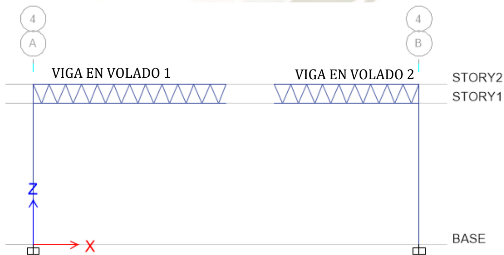
Figura 92. Eliminación de elementos de la brida superior y diagonales que llegaron a la falla. [Fuente: Elaboración propia mediante software "Etabs 2016"]
