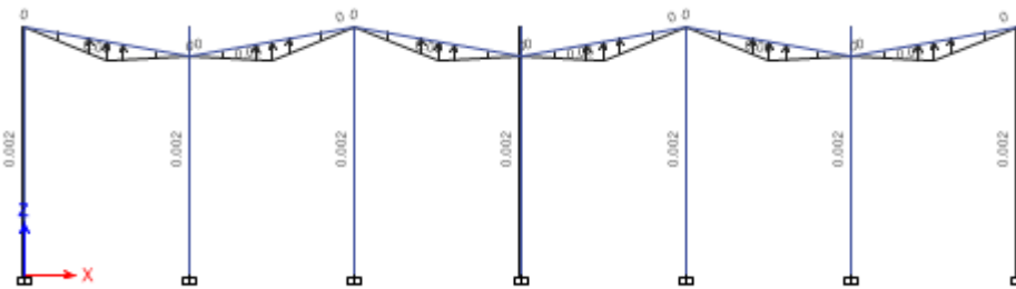
Figura 118. Aplicación de cargas en arriostres de la estructura en análisis. [Fuente: Elaboración propia mediante software "Etabs 2016"]
