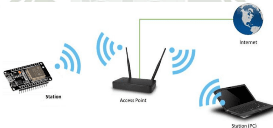
Figura 52 Comunicación modo Station
