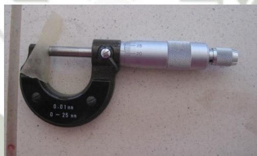
Figura N° 18. Medición del espesor con el micrómetro
