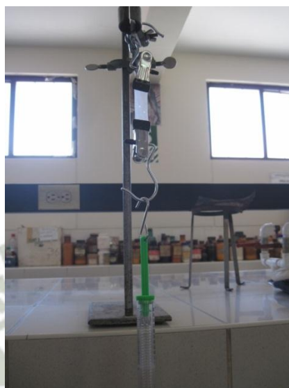
Figura N° 17. Sistema de medición de tensión
