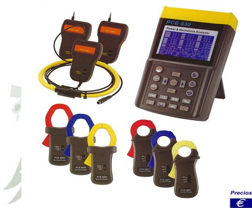
Fig. N°10: Analizador de redes típico y sus principales accesorios
