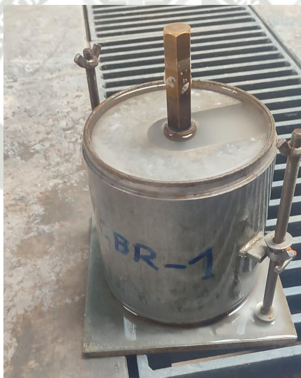
Figura 26. Finalizado el periodo de inmersión, se sacan los moldes y se espera por unos 15 min, que el agua sobrante discurra.
