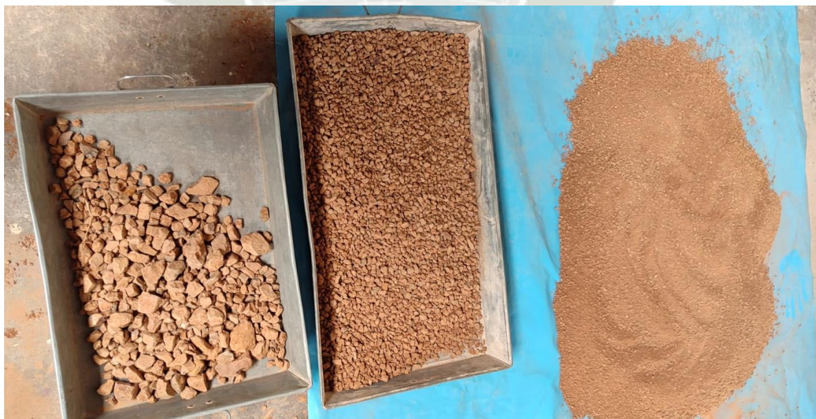
Figura 12. Para los ensayos posteriores, se hace secar el material a temperatura ambiente, extendiéndolo en el área designado para guardar las muestras.
