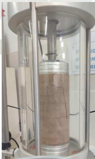
Figura 36. Se finaliza el ensayo, cuando la carga empieza a reducir y también cuando visualmente el molde presenta grietas.
