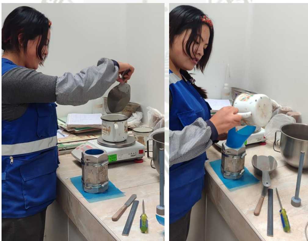
Figura 30. Teniendo la densidad definida, se pesa el material por capa a compactarse, dentro del molde establecido en una relación de altura: diámetro de 2.
