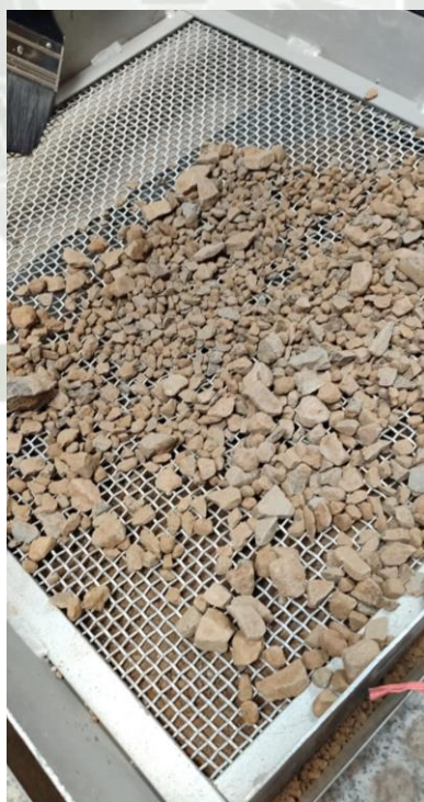
Figura 8. Se tamiza dividiendo las gravas de los finos, mediante la malla N 4, para realizar el tamizado de ambos por separado.
