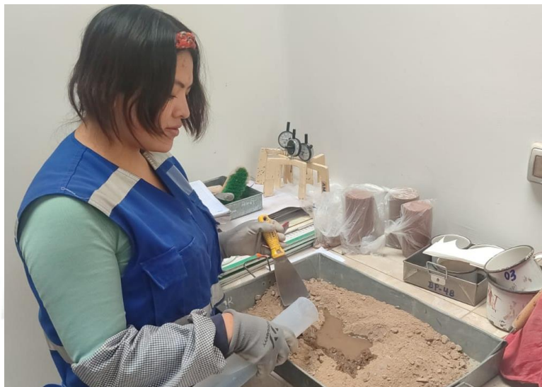
Figura 19. Para el ensayo de Proctor modificado, se prepara el material según la granulometría del suelo, para mezclarlo a distintos contenidos de humedad.
