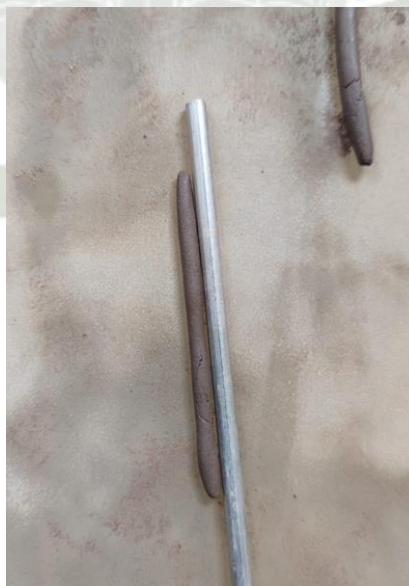
Figura 14. Para el ensayo de Limite plástico, el material fue saturado y curado unas horas antes para realizar el ensayo el cual se hará hasta el desmoronamiento y/o agrietamiento, de los rollitos de suelo, con el diámetro indicado.
