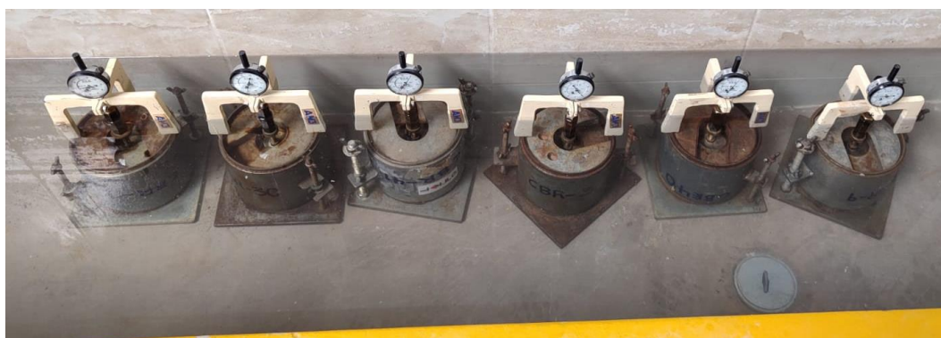
Figura 25. Los moldes, se sumergirán durante 96 horas, durante este periodo, se anotarán las expansiones.
