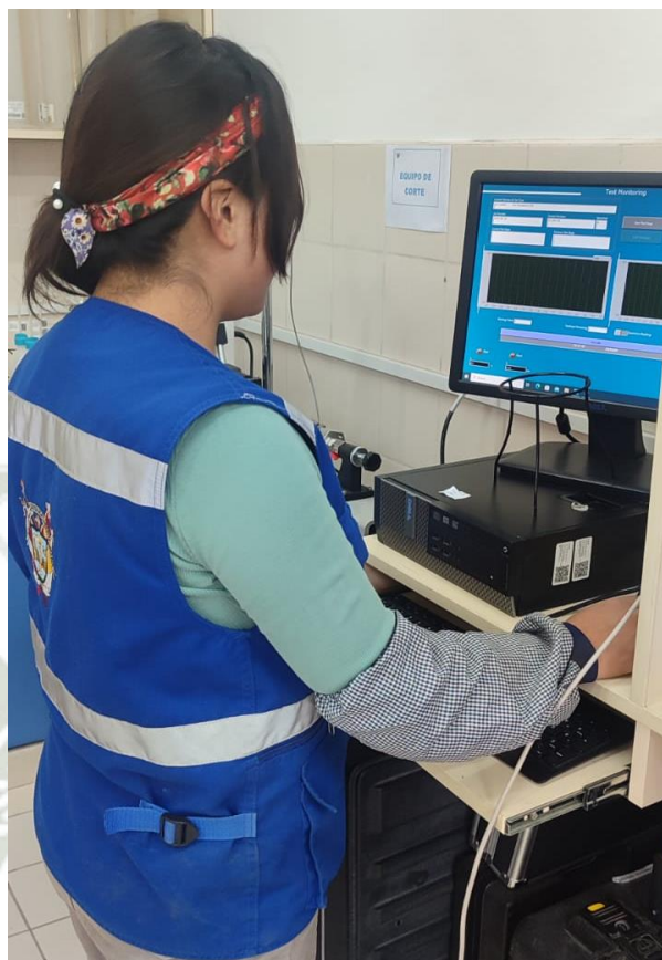
Figura 35. Para iniciar el ensayo se programó la velocidad y se configura los datos para que se realice el ensayo axial de la muestra.
