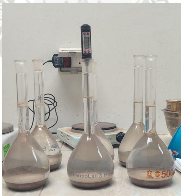
Figura 18. Por ultimo se pesan y se toma la temperatura a la cual se encuentra la muestra.
