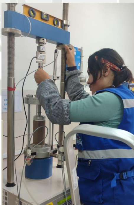
Figura 34. Una vez asegurada la capsula donde esta el espécimen, este se centrara en el equipo triaxial, cuidando de los niveles del equipo y que este centrada y en contacto el dispositivo de carga
