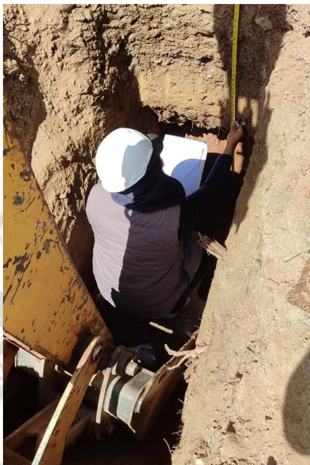
Figura 5. Una vez identificada la zona de estudio, se procede a la excavación para obtener las muestras representativas del suelo y su respectiva descripción de estratos.
