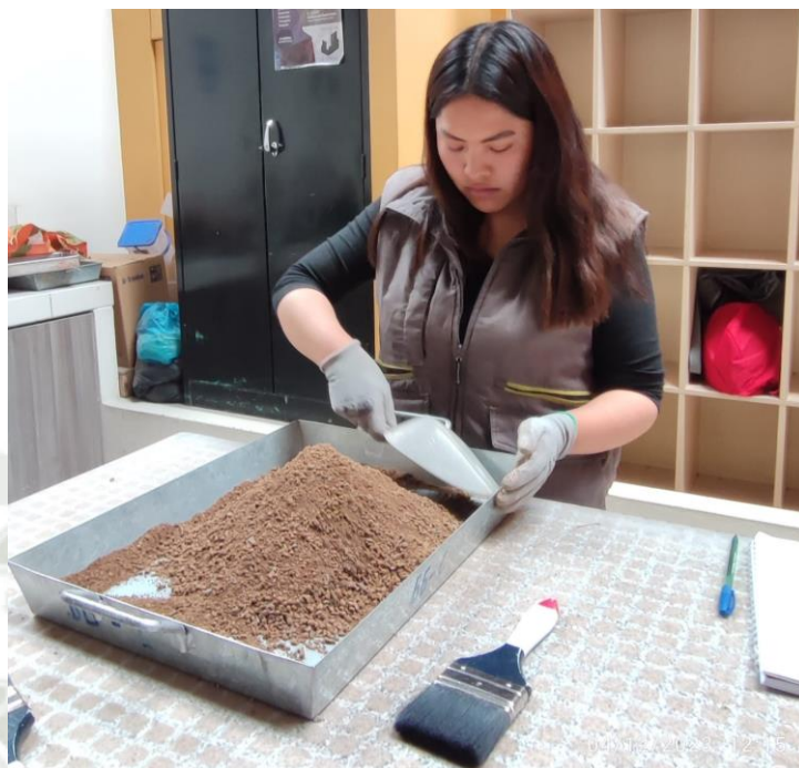
Figura 7. Se realiza el ensayo de granulometría, para lo cual se escogió una muestra representativa, mediante el cuarteo del material.
