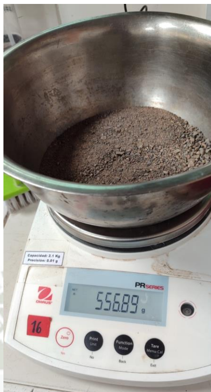
Figura 11. Ya lavado y secado el material, se realizará el análisis granulométrico de los finos.
