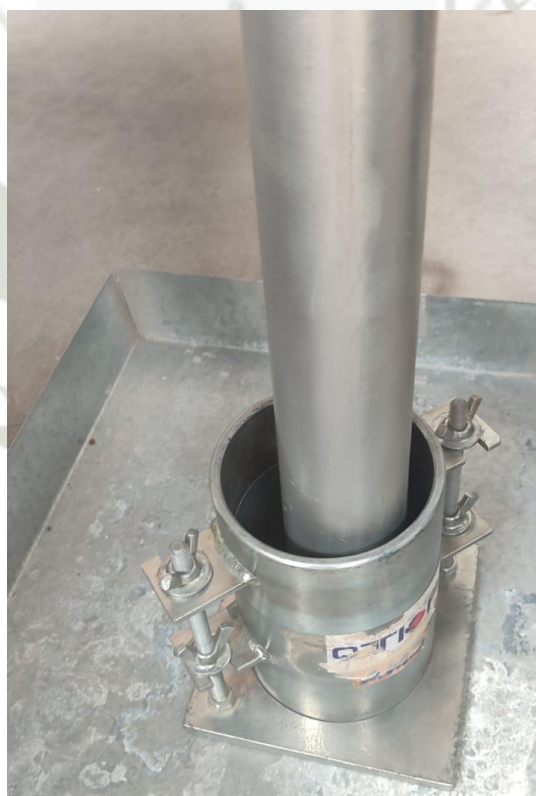
Figura 20. Con la mezcla obtenida, se procede a realizar la compactación usando un pisón manual, según el método “B” o “C”, será el tamaño del molde y la cantidad de golpes por capa.
