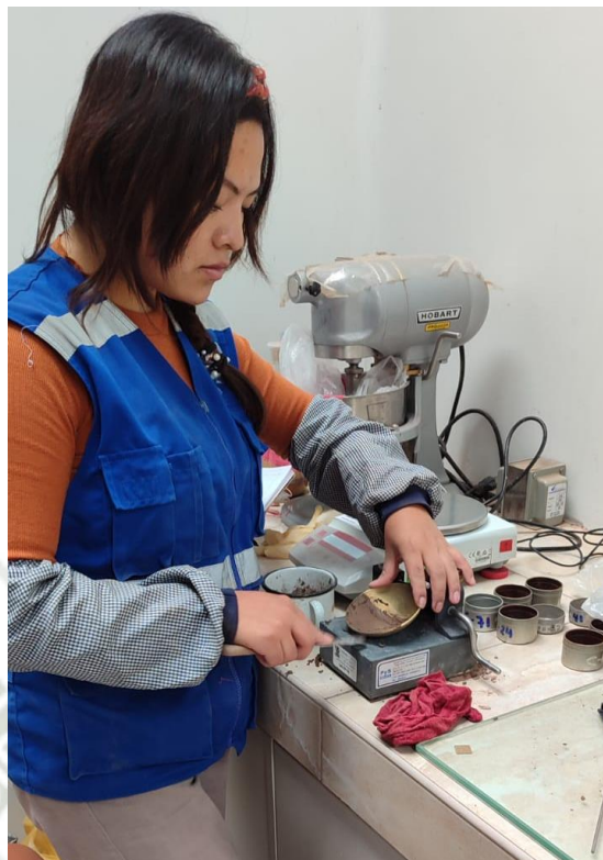
Figura 13. Para el ensayo de limite líquido, el material fue saturado y curado unas horas antes para realizar el ensayo utilizando la cuchara de Casagrande.
