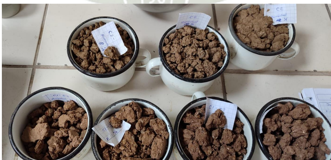
Figura 22. Finalmente, se hallará el contenido de humedad de la muestra ensayada.
