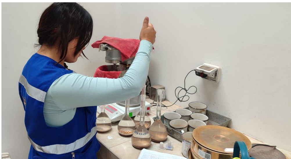
Figura 17. Enfriado las fiolas ya desaireadas, se procede a llenar con agua hasta el nivel de calibración que se realizó anteriormente.
