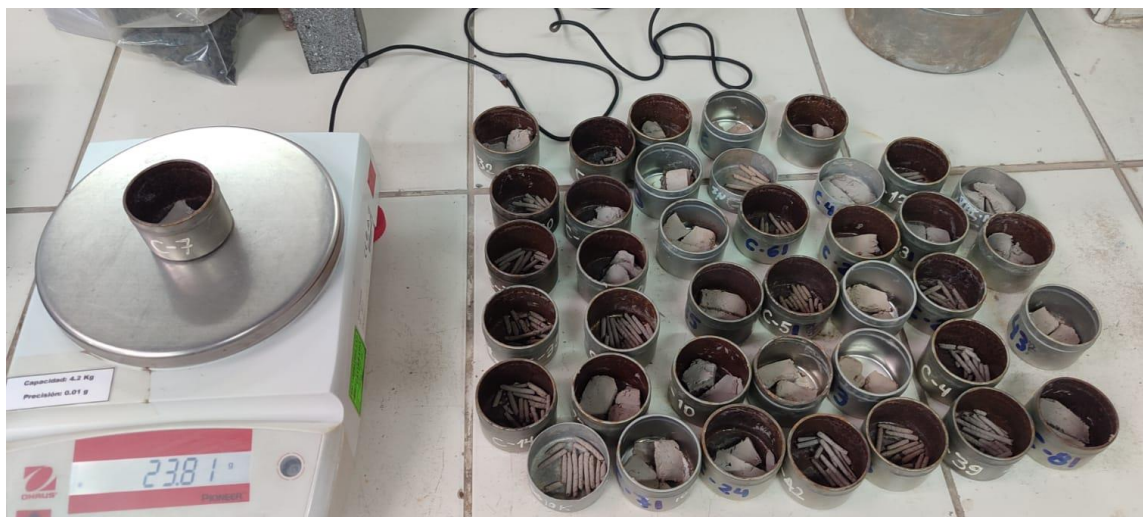
Figura 15. Luego de terminar de ensayar los materiales, se pesará, para finalmente, introducirlo al horno y secar, para hallar el contenido de humedad.
