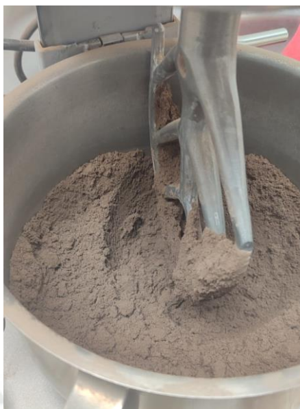
Figura 29. Para el ensayo de compresión simple no confinada, se utilizó la mezcladora manual, para mejor combinación del suelo con el agua.
