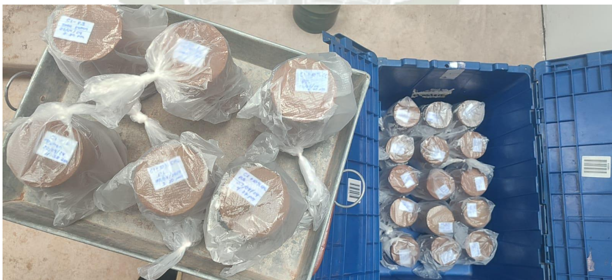
Figura 32. Para cada muestra, se realizo 3 repeticiones, los cuales se curo en un ambiente hermético durante 7 días.
