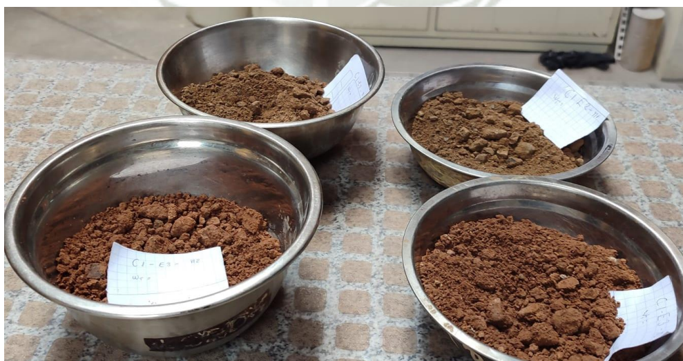
Figura 6. Se realiza el ensayo de contenido de humedad, de las 03 calicatas.
