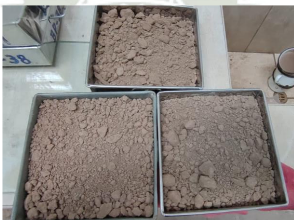
Figura 28. Finalmente se haya las humedades de los suelos ensayados, antes y después de la inmersión.
