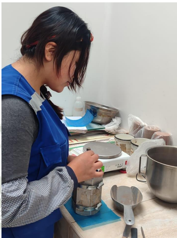
Figura 31. Se compacto dividiendo el molde en 10 capas, teniendo la densidad establecida.
