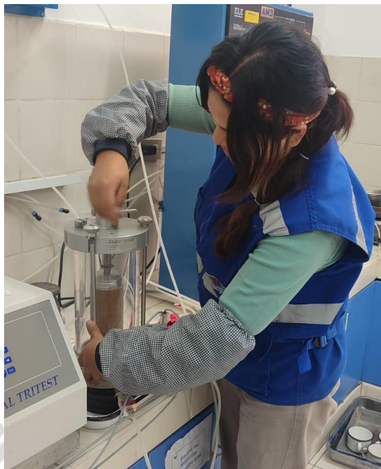
Figura 33. Para el ensayo se usó el equipo triaxial, donde los especímenes deben centrarse y se aseguró la capsula del equipo.
