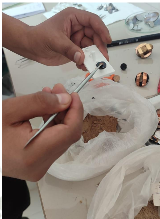
Figura 37. Para el estudio microestructural del suelo, CFL y las adiciones, las muestras pasan por un baño de oro.
