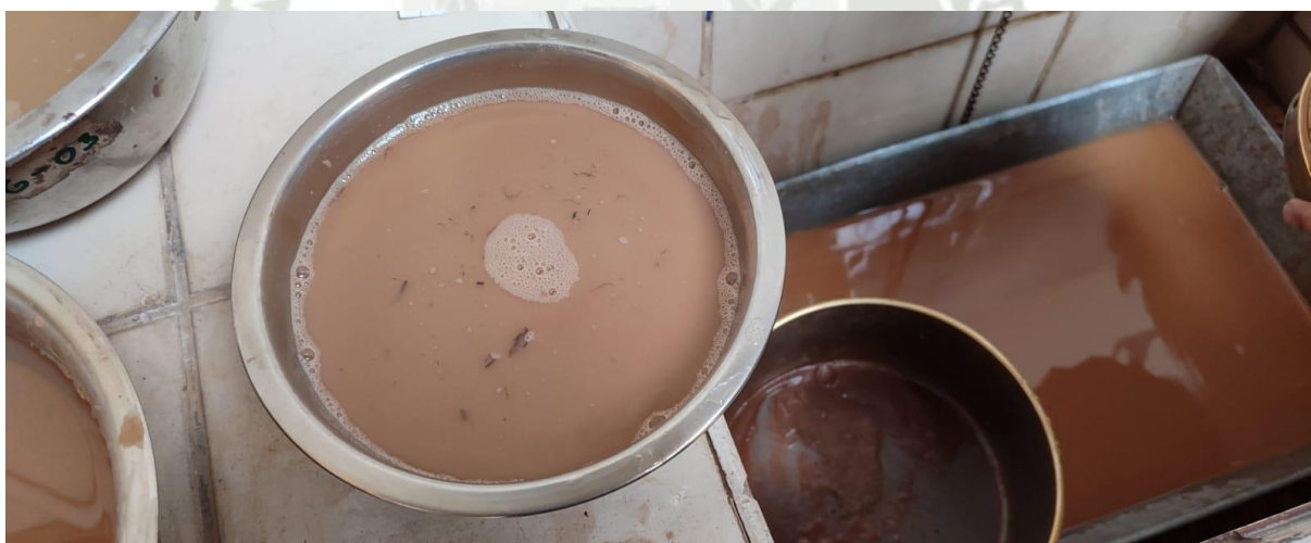
Figura 10. Para el análisis granulométrico de los finos, se realiza un lavado del material teniendo cuidado de perder material, este se lavará hasta que el agua este clara.
