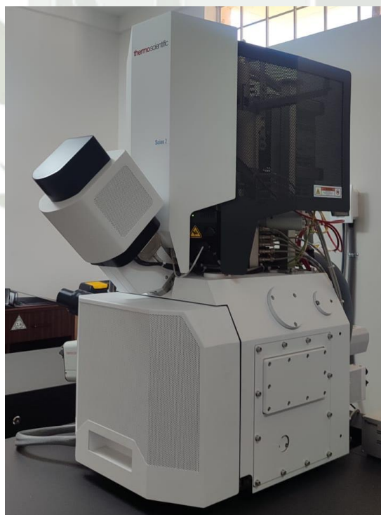
Figura 38. Equipo de SEM, para la caracterización de las muestras, mediante el uso de cañón de electrones
