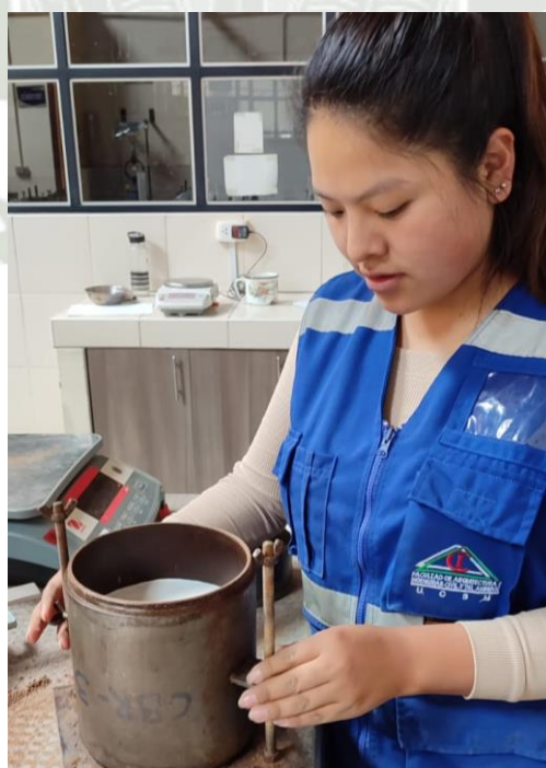
Figura 24. Terminada la compactación se colocará papel filtro, para luego poner las cargas y el dial que medirá la expansión.
