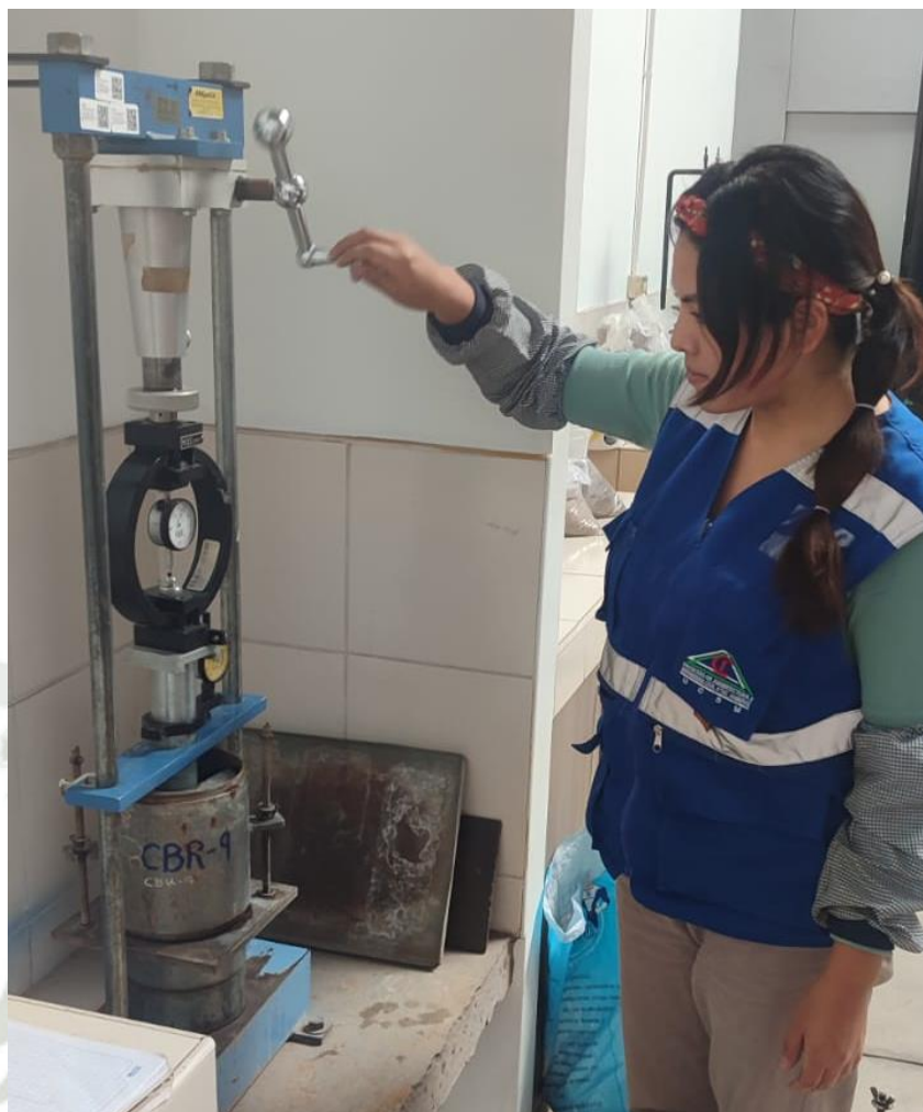
Figura 27. Para el ensayo se usa la prensa de carga, el cual a determinados tiempos se anota lo que indica el dial de carga, realizado según la norma del MTC.
