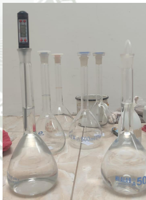
Figura 16. Para el ensayo de Gravedad específica de los finos, se realiza una calibración de las fiolas a usarse, así como la medición de la temperatura del agua a usarse, para proceder a realizar el desaireado de la pasta mediante ebullición, hasta que la mezcla suelo- agua llegue a hervir.
