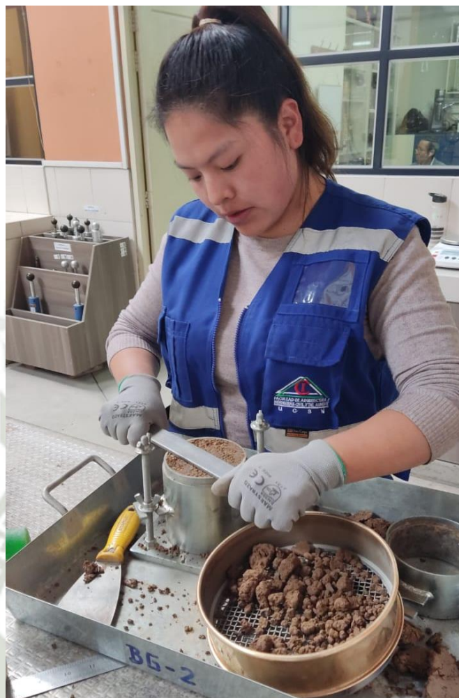
Figura 21. Posterior a la compactación, se quita el collarín y se procede a enrasar, llenando los espacios si hubiese, con material propio de la muestra.
