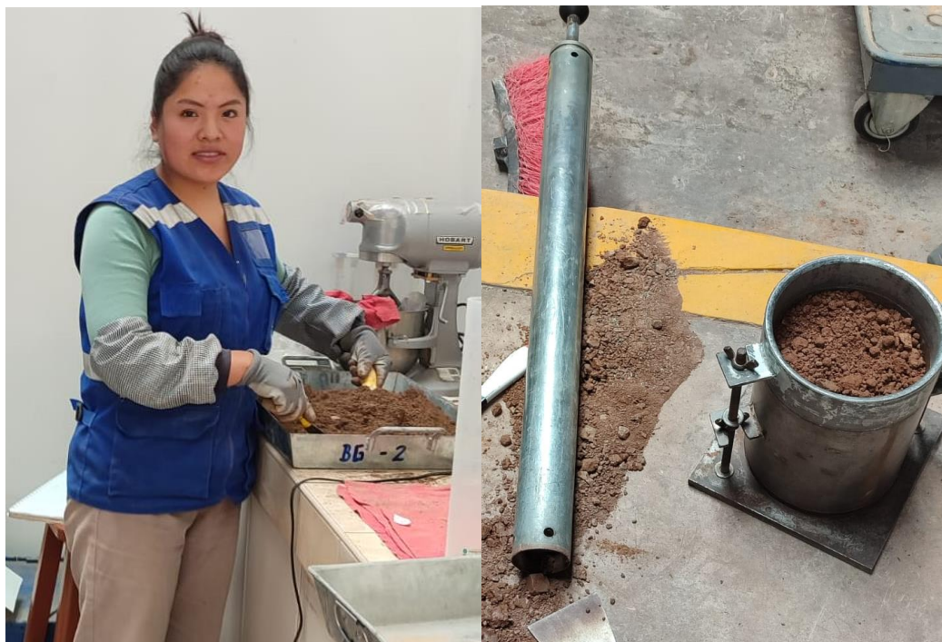
Figura 23. Para el ensayo de CBR, se preparará el material según su granulometría y el óptimo contenido de humedad hallado anteriormente, se compactará en un molde de 6'' a 12, 26 y 55 golpes por capa.
