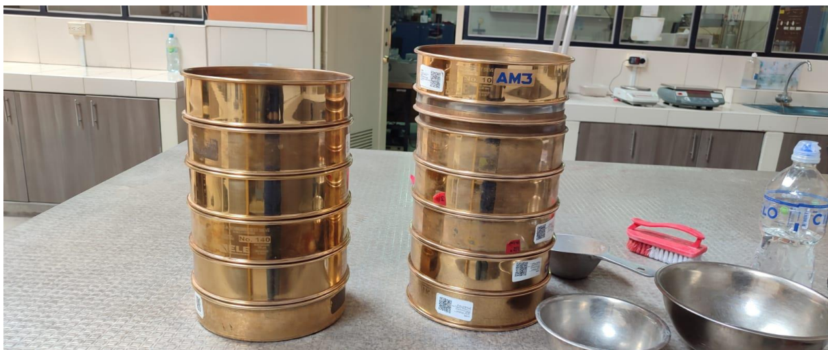
Figura 9. Los equipos y herramientas manuales, para realizar el ensayo de granulometría, según lo indicado en la norma MTC.
