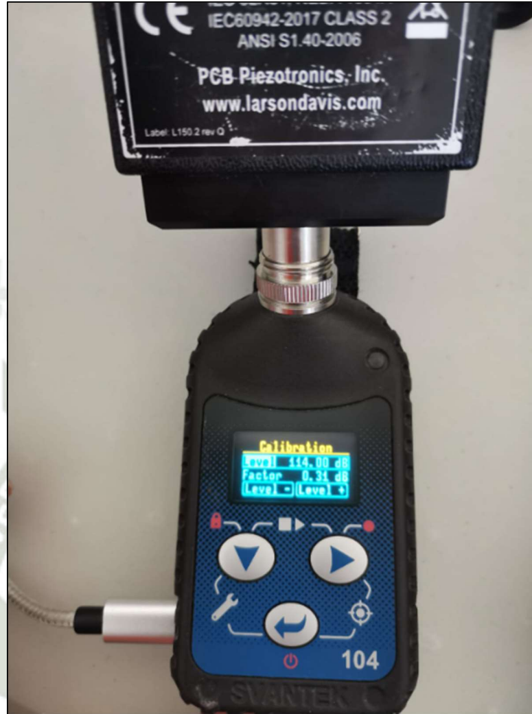
Figura 10. Calibración del Dosímetro de ruido, modelo SV 104 marca Svantek
