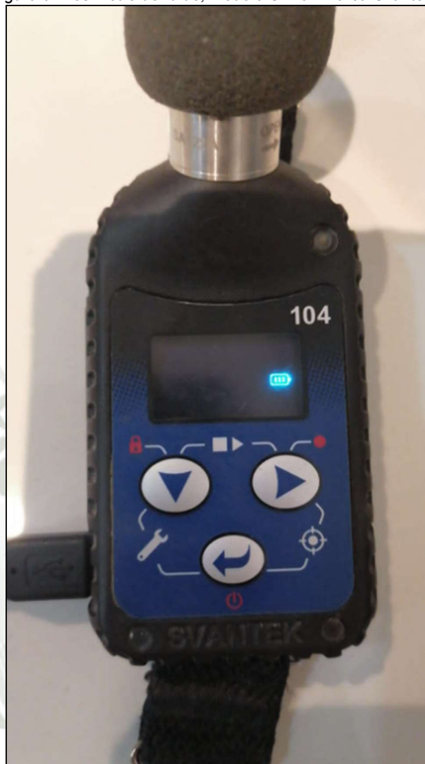
Figura 9. Dosímetro de ruido, modelo SV104 marca Svantek
