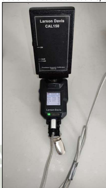
Figura 3. Calibración de Dosímetro modelo Spartan 730
