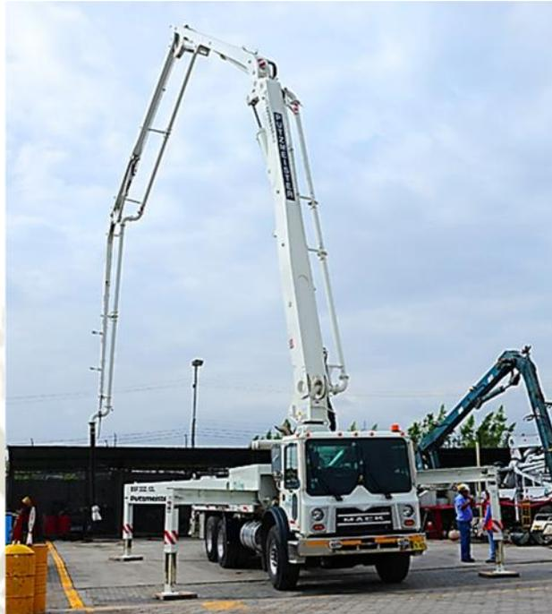
**Fotografía 1: Camión bomba concretera para vaciado de concreto a gran altura**
