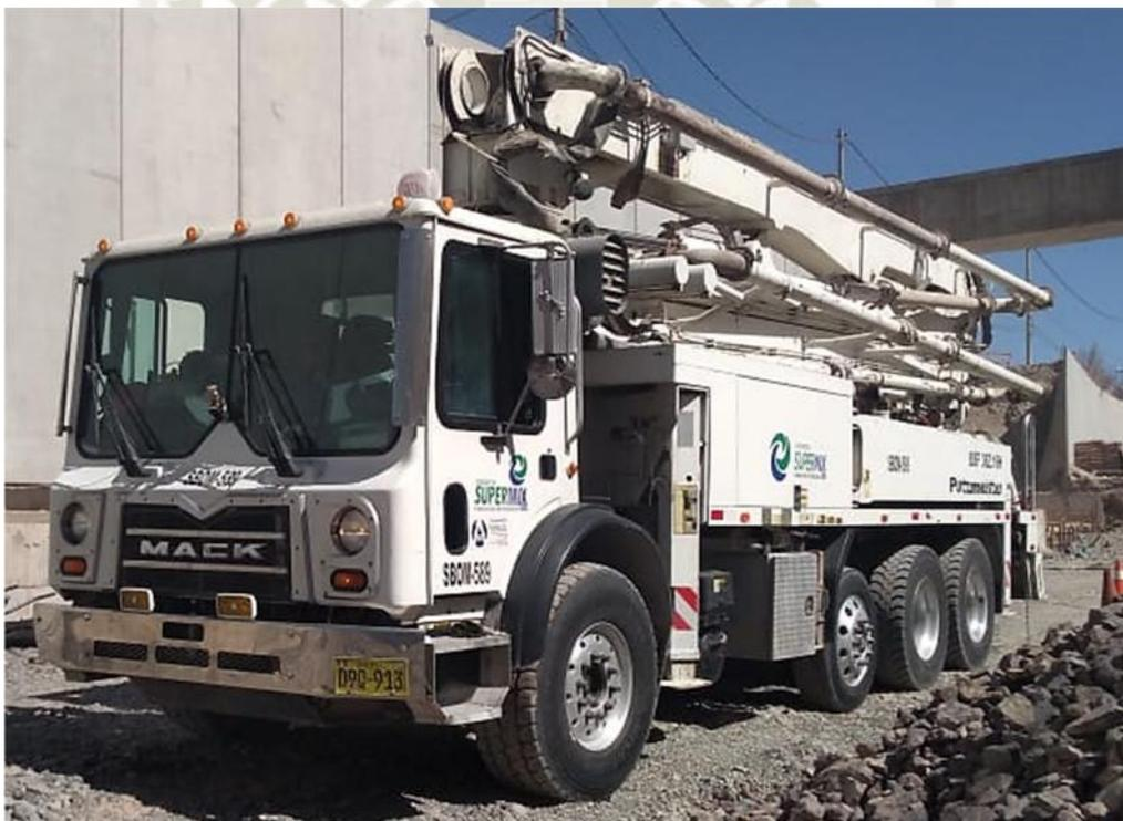
*Fotografía 8: Equipo Bomba telescópica o Concretera.*
