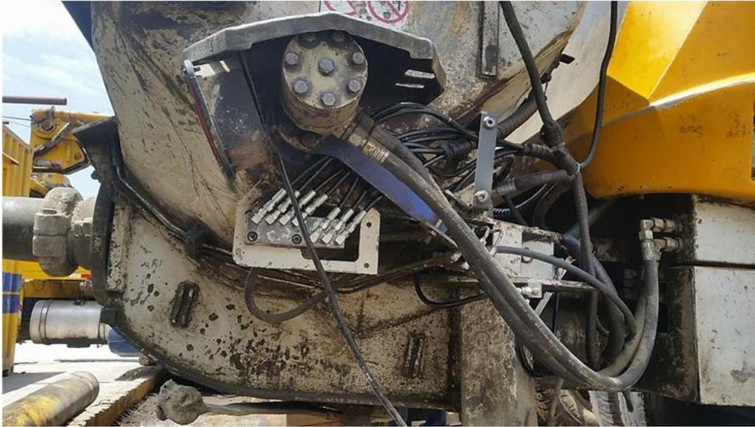
*Figura 67: Componente de Batea con Sistema de Lubricación Automática.
