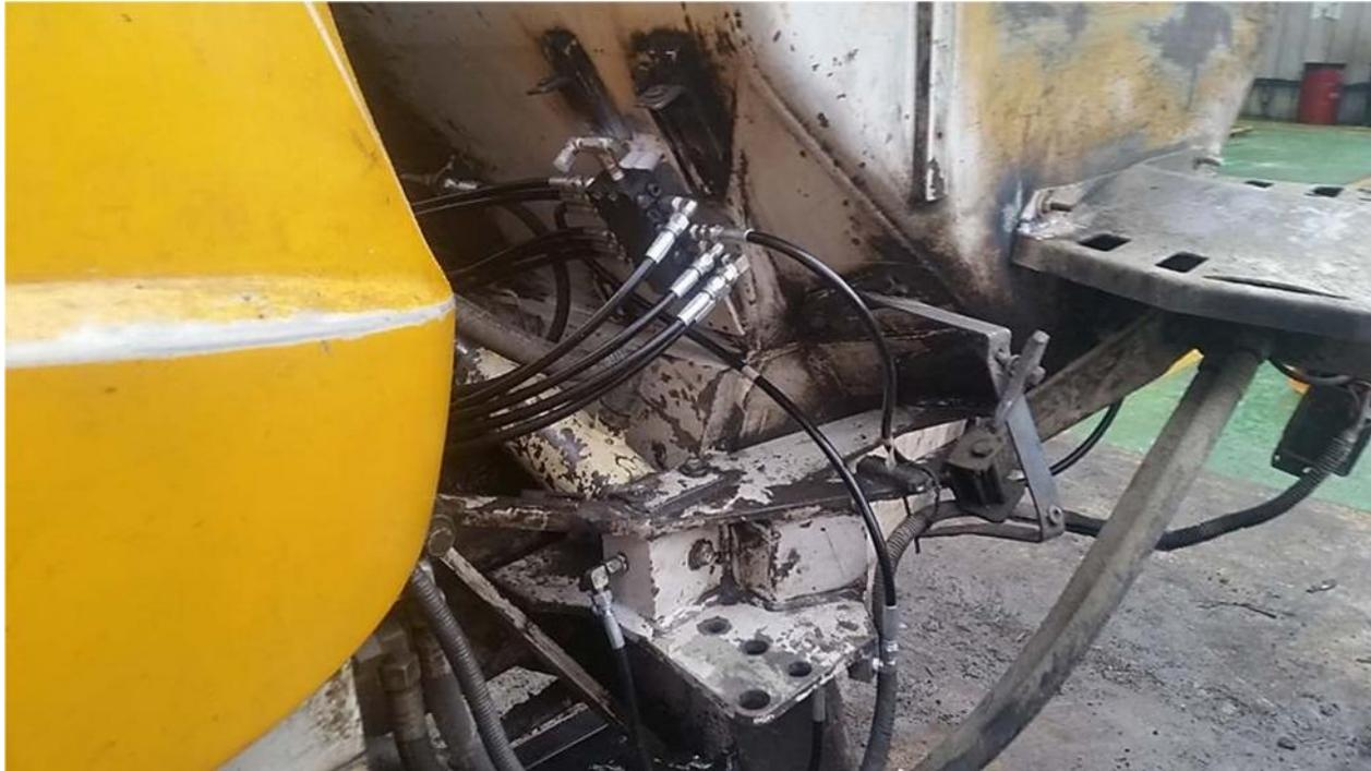
*Figura 69: Válvula Distribuidora de grasa instalada.*
