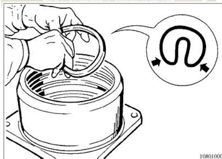
Doblar las juntas de estanquidad para facilitar el montaje
