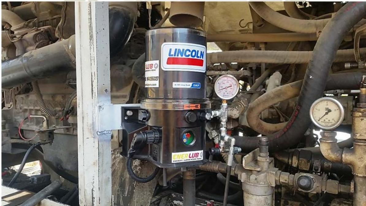
*Figura 68: Bomba de Grasa Automática Instalada.
