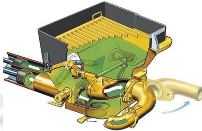
**Figura 15: Tolva Mezcladora de Bomba de Concreto Putzmeister.**
