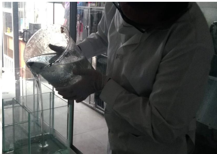
Figura N°7. Preparación de la primera capa de resina cristal poliéster.
