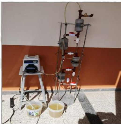
Fig 40. Diseño de columna de filtración con residuos agroindustriales y componentes inorgánicos (46).
