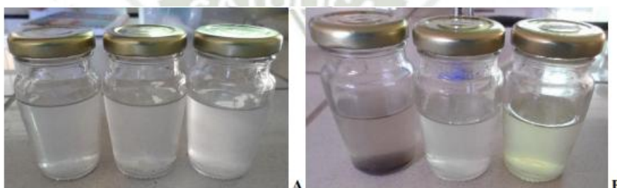
Fig 74. Bioprecipitación de Pb, Cr, y Cd; inicio (A) y final (B) (54).
