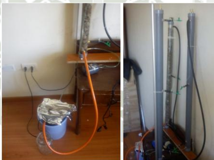
Fig 14. Biorreactor REFA-EZ continuo de 3 columnas (32).
