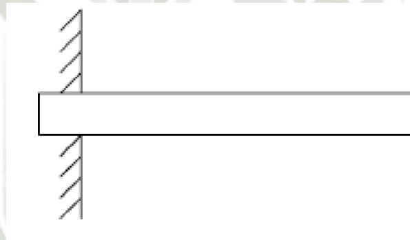
Figura 33. Modelamiento del soporte de pie y cabeza del cilindro como viga empotrada y libre en el otro extremo
