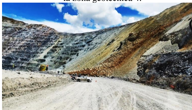
Figura 37. Rampa 9 bloqueado por desprendimiento de gran volumen de material de la zona geotécnica 4.
