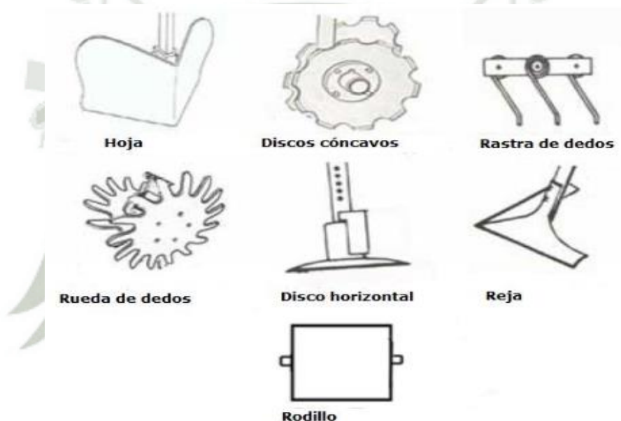
Gráfico N° 6: Siete tipos de elementos para preparación del suelo
