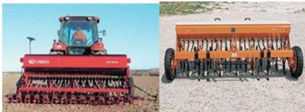
Gráfico N° 16: Sembradora a Chorrillo o en Línea
