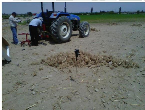
Gráfico N° 36: Prueba de esfuerzos del suelo
