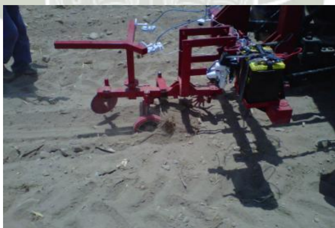
Gráfico N° 32: Prueba del abridor de disco cóncavo
