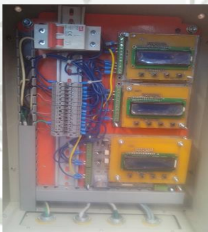
Gráfico N° 109: Sistema de Control de Caída de Semilla
