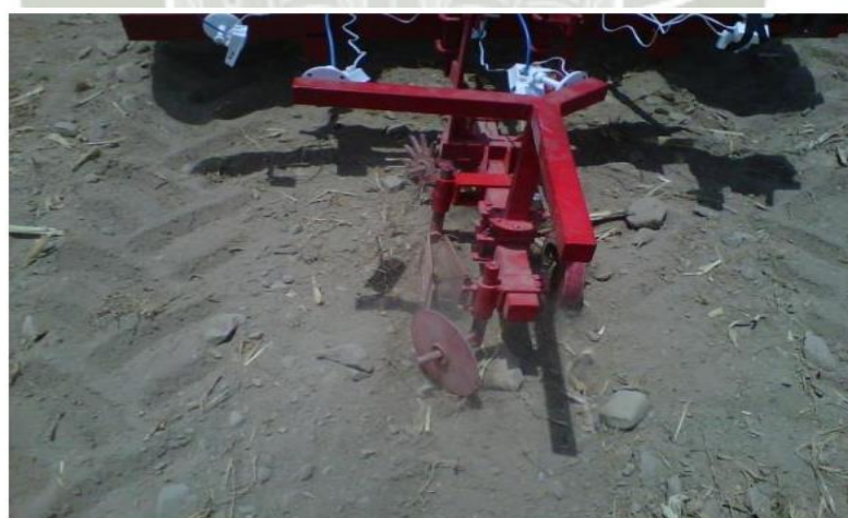
Gráfico N° 34: Prueba del abridor tipo bota
