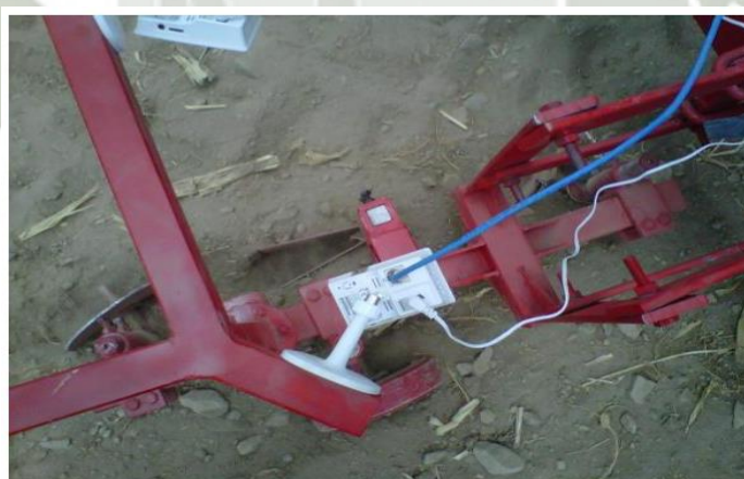
Gráfico N° 33 Prueba del abridor de surco tipo reja
