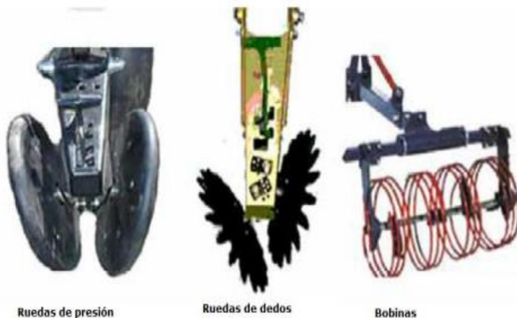
Gráfico N° 8: Tres tipos de mecanismos para afirmar el suelo sobre el surco de siembra
