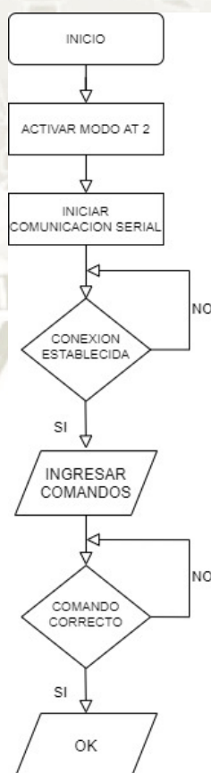
Figura 37. Diagrama de flujo para la configuración del módulo bluetooth
