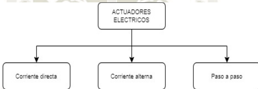
Figura 13. Clasificación de los actuadores eléctricos por el tipo de energía de alimentación [41].
