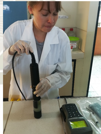
Imagen 22: Medición de parámetro físico – químicos con el multiparametro HI9829
