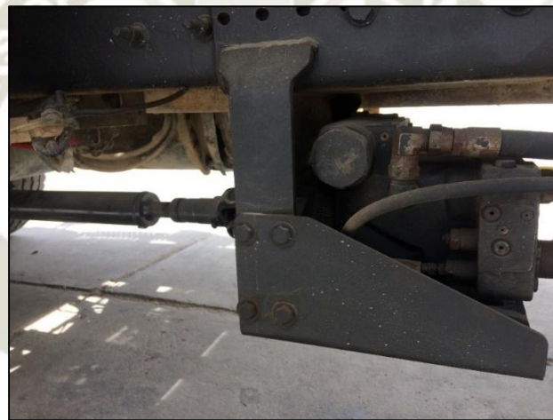
Imagen 37: Cardan PTO y Bomba hidráulica Fuente: Elaboración propia
