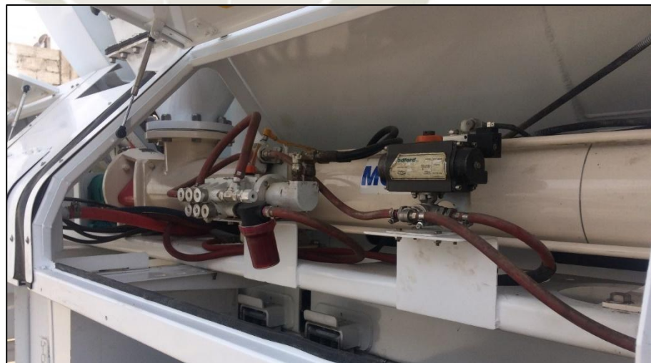
Imagen 53: Bomba de Cavidad Progresiva
