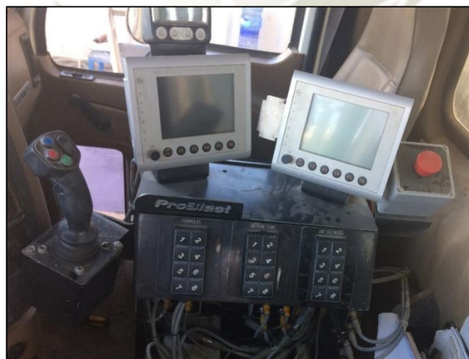
Imagen 36: Pantallas y mandos del sistema PROBLAST
