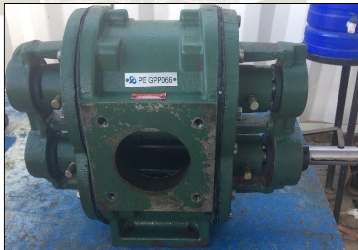
Imagen 51: Bomba de emulsión de doble succión
