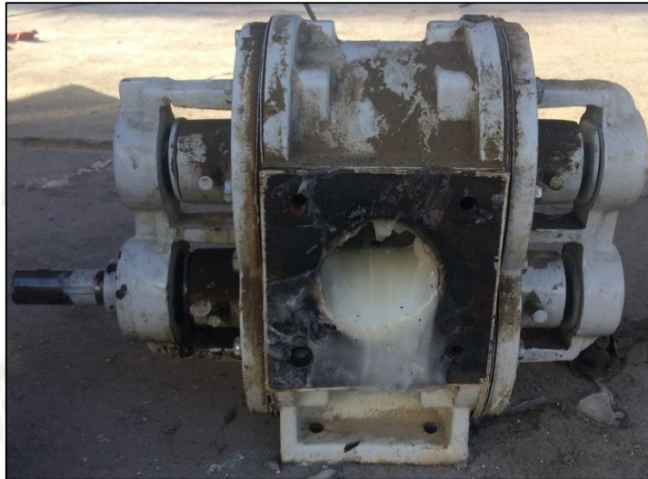
Imagen 52: Bomba de emulsión con retenes vencidos
