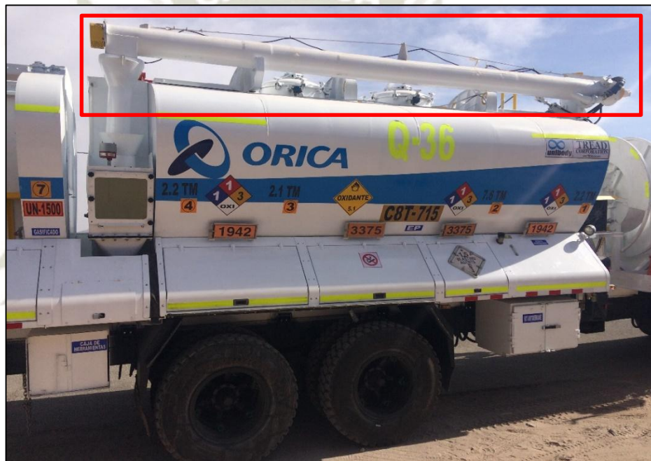
Imagen 45: Sin fin de descarga
