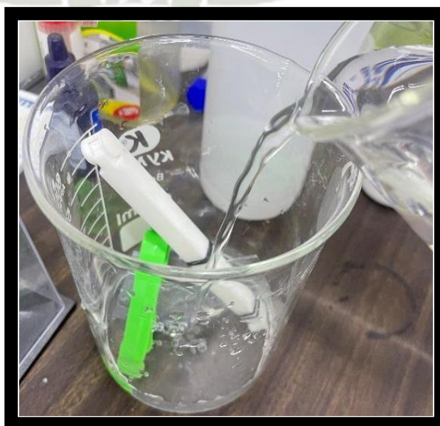
Figura 1: Vaso de precipitados, en su interior se observa la bolsa con el contenido a dializar.
