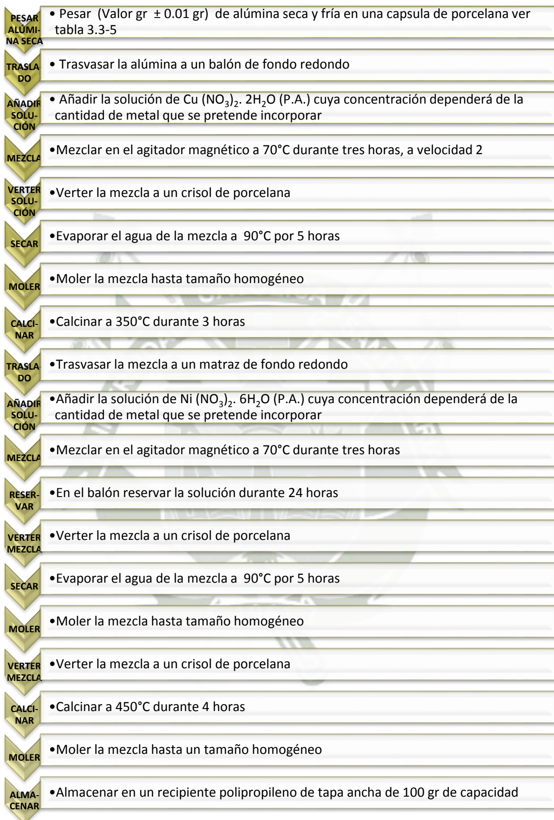
Ilustración 3-3: Procedimiento de Preparación del Catalizador Fuente: Elaboración Propia
