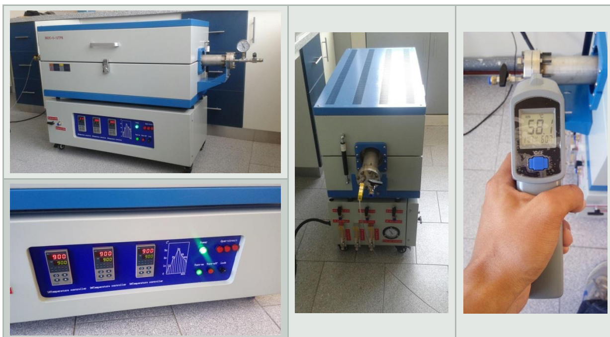
Ilustración 4-9: Procedimiento de Prueba 1 Fuente: Elaboración Propia
