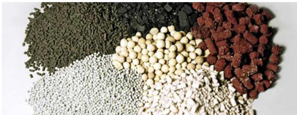
Ilustración 2-17: Catalizadores industriales de diferentes formas y tamaños Fuente: Bairec, ibérica.
