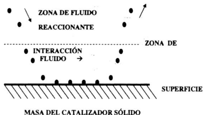
Ilustración 2-16: Representación Esquemática de la Acción Catalítica Fuente: Luis M. Caballero Suárez, Introducción a la catálisis heterogénea
