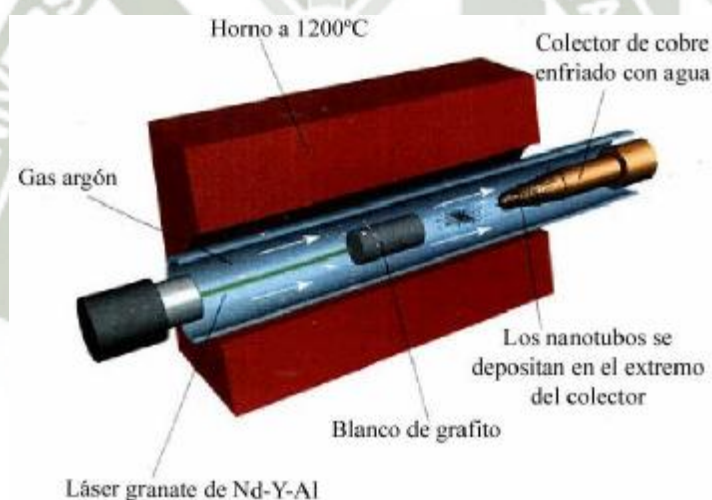
Ilustración 2-9: Esquema del sistema de síntesis de CNF/CNTs por vaporización por láser Fuente: Vicente Jiménez Cotillas, Síntesis, Activación Química y Aplicaciones de Nanoestructuras de Carbono
