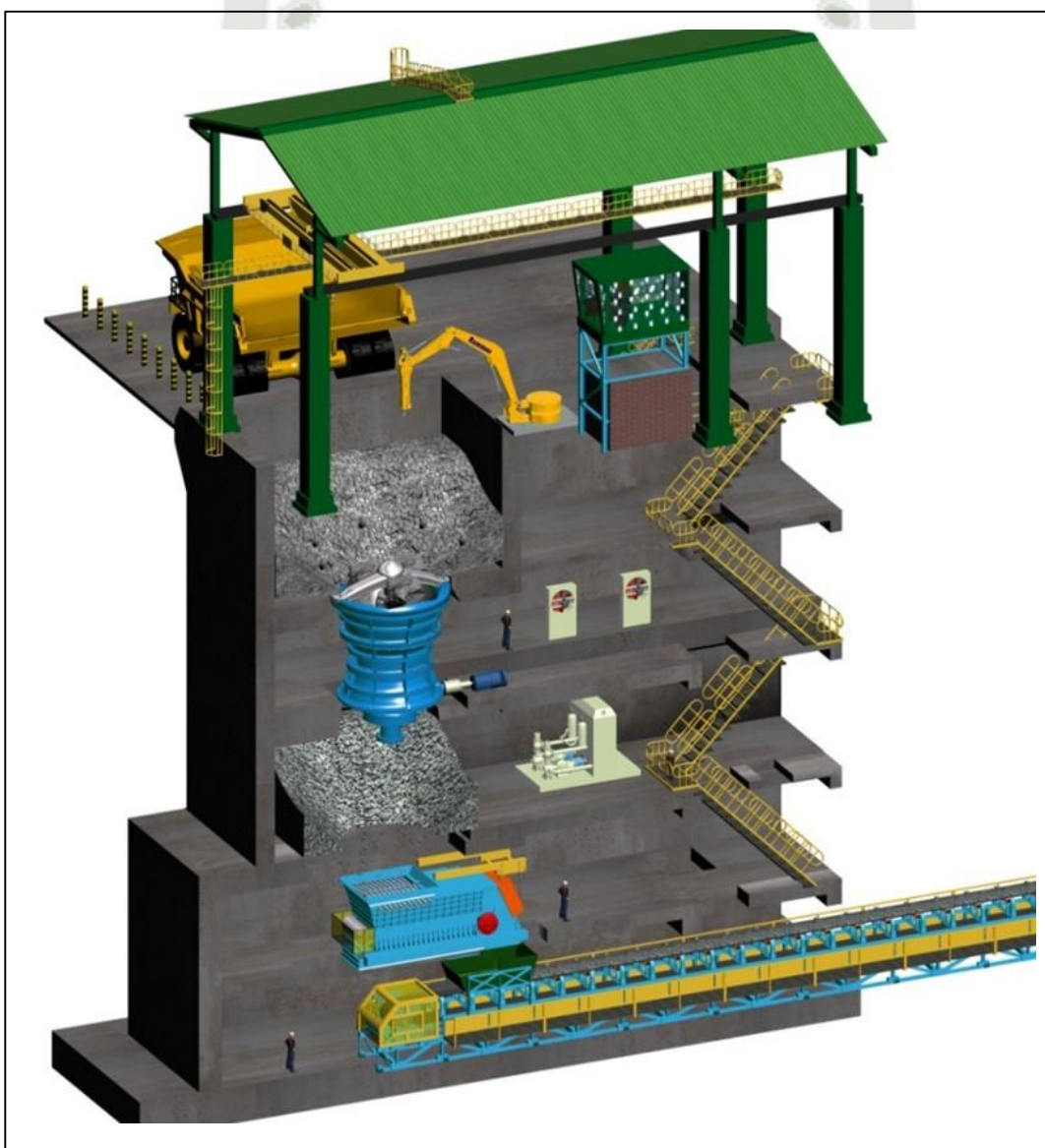
FIGURA N° 4: Corte 3D del Circuito de Chancado Primario
