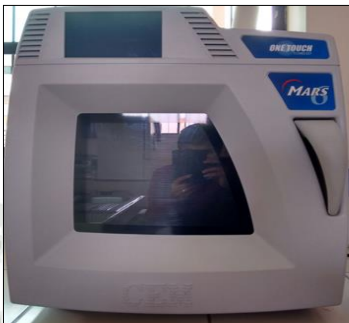
FIGURA 2.5. Digestor microondas MARS utilizado para realizar las digestiones de raíces y hojas de Bacopa monnieri L. (Hisopo de agua).
