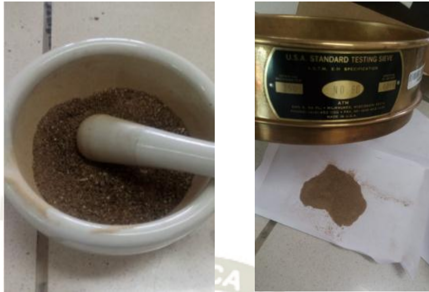
Figura 20: Pulverizado de la cáscara de papa
