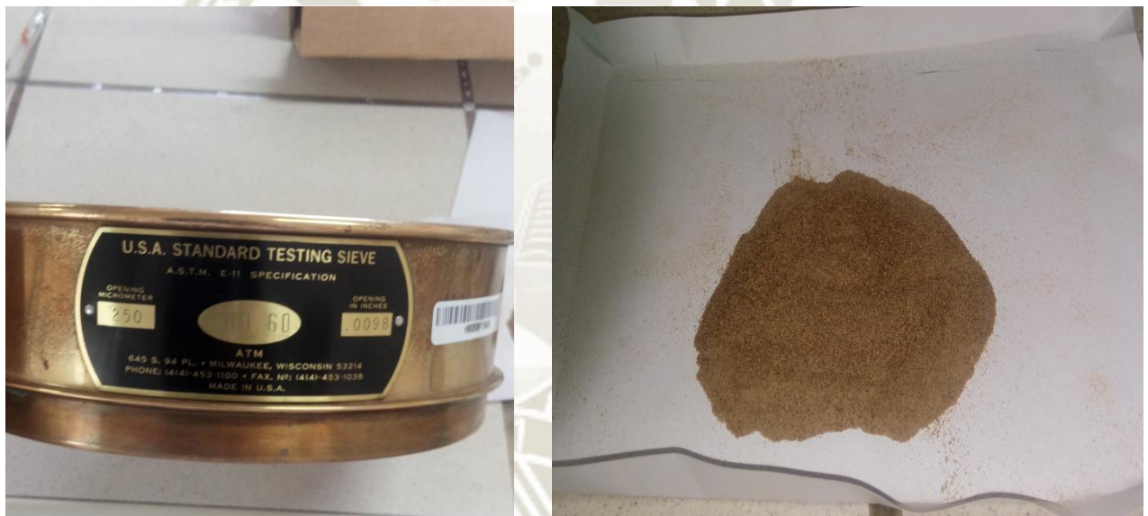
Figura 21 Tamizado de la biomasa
