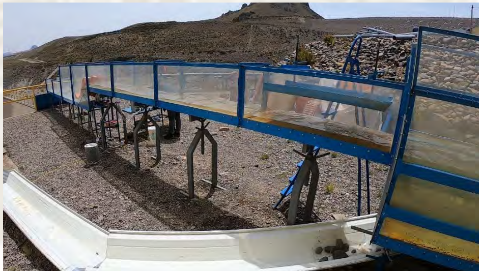
Figura38: Recorrido del flujo aguas arriba y nivelación.
