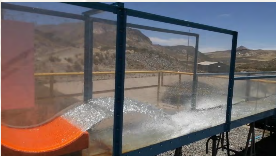
Figura42: Geometría del chorro
