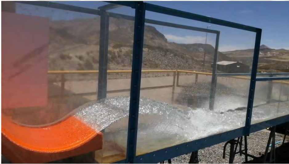
Figura41: Cubeta deflector, geometría del chorro
