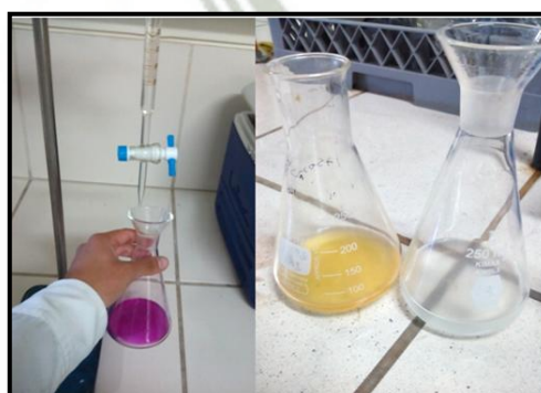
Figura N° 26. Titulación con ácido clorhídrico, índice de saponificación
