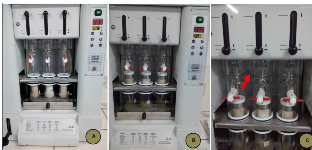
Figura N° 15. Extracción con solventes – Método de Randall. En la imagen A se observa el paso de ebullición, en la imagen B el paso de enjuague y en la imagen C etapa de recuperación del solvente.
