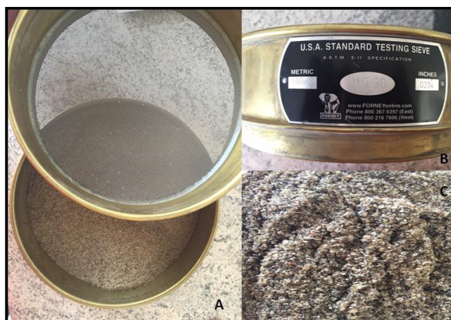
Figura N°22. Tamizado de harina de chíá, en la imagen A se muestra el proceso de uniformizado, en la imagen B se muestra el tamiz empleado N° 30, en la imagen C se observa la harina obtenida luego del proceso de tamizado.
