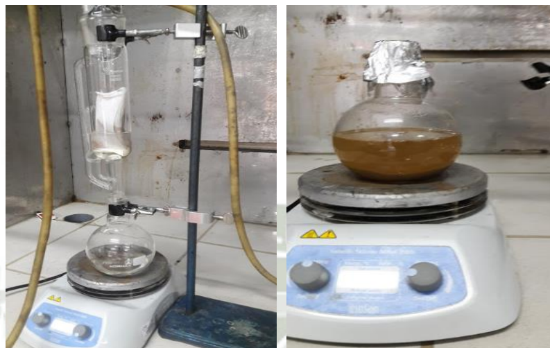
Figura 34. Procedimiento para la determinación de extraíbles
