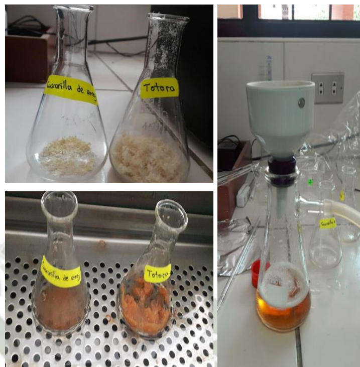
Figura 38. Procedimiento para la determinación de celulosa
