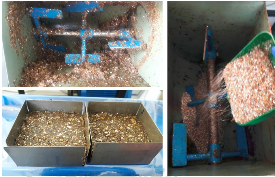
Figura 46. Proceso de mezclado en la elaboración del biocomposito
