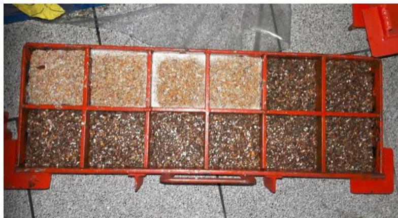
Figura 48. Moldes con diferentes mezclas listas para el proceso de secado
