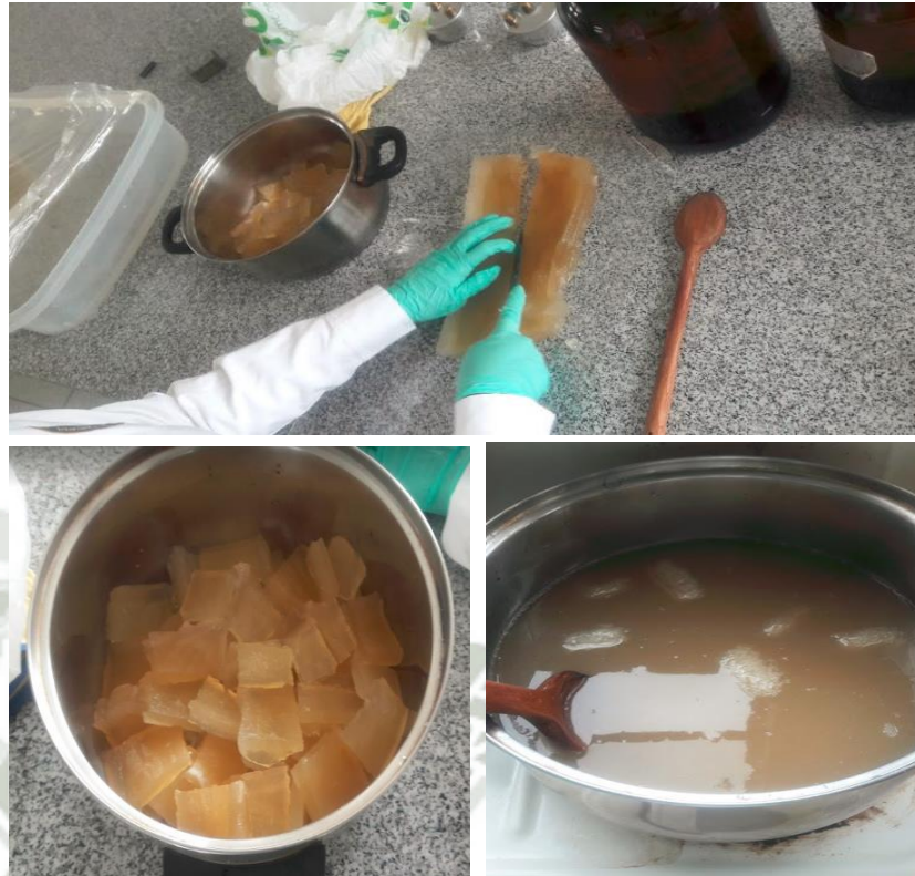
Figura 44. Procedimiento para la elaboración del adhesivo a base de residuos de camal.
