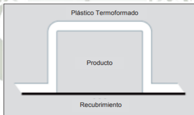
Figura 9. Configuración de un envase tipo blister (Pilchik, 2000)
