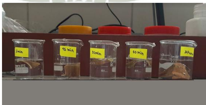
Figura 16. Determinación de la capacidad de absorción de agua de fibras naturales
