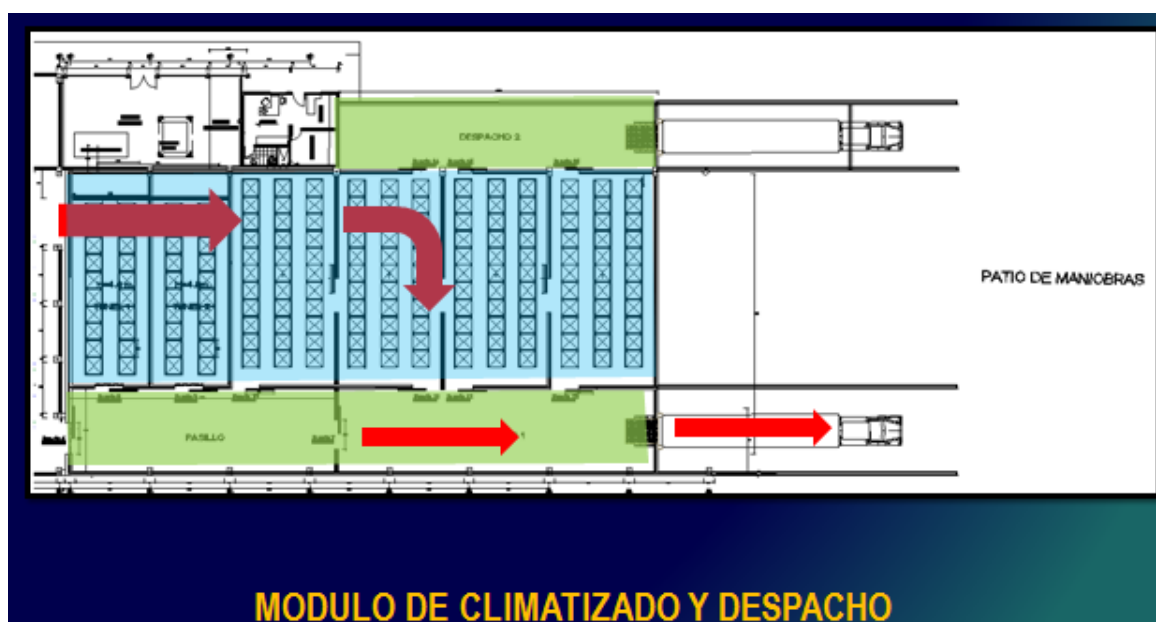
Fig. 19: Distribución de las cámaras de Refrigeración del Packing en estudio Fuente: Proyecto Packing de La Joya
