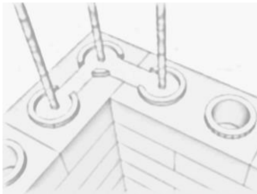
Figura N° 1 COLUMNAS CON LADRILLOS HECHOS CON SILLAR
