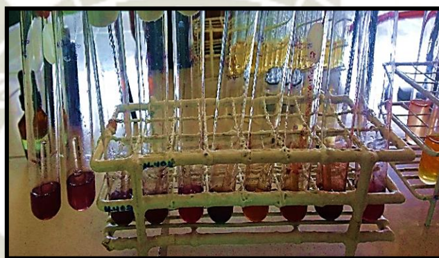
FIGURA N° 43 : Reacción de reducción de Nitratos
