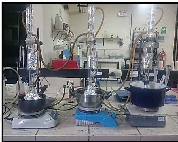
FIGURA N°33 : Extracción de la muestra por equipo Soxhlet con diferentes solventes
