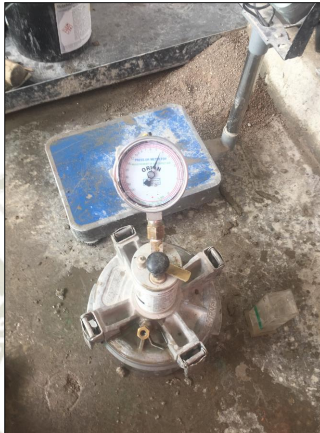
Figura 26. Contenido de aire en el concreto.
