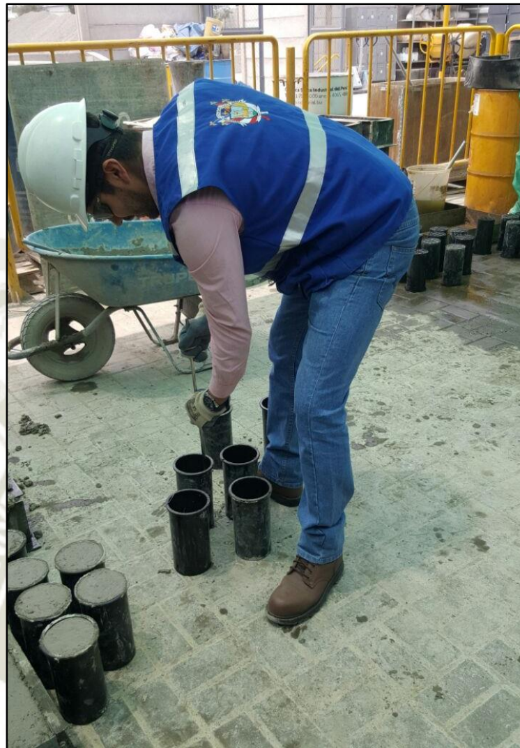
Figura 24. Moldeo de probetas.
