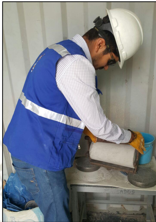
Figura 37. Rotura de probeta inclinada.
