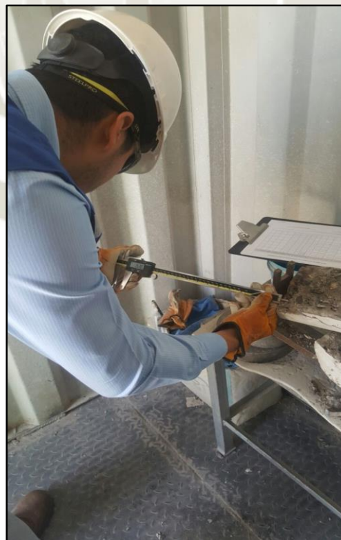
Figura 38. Medición de profundidad de penetración.
