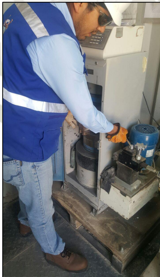
Figura 30. Rotura de probetas de concreto.
