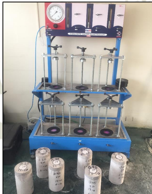
Figura 33. Equipo de permeabilidad de agua.
