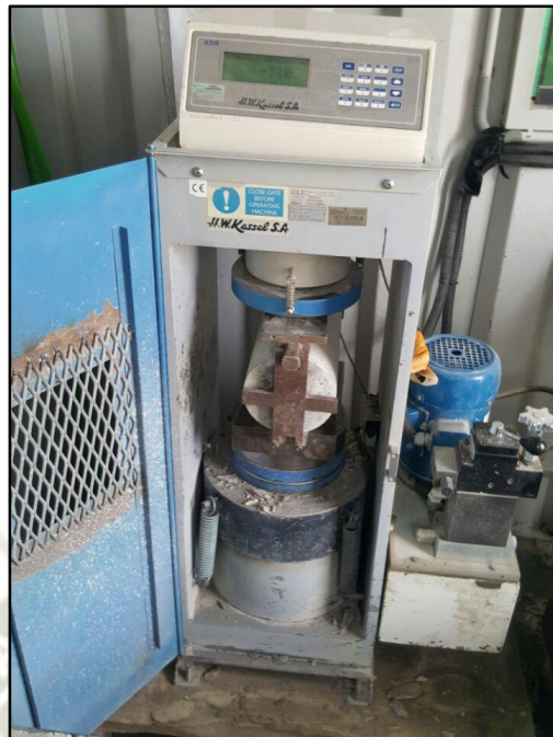
Figura 29. Prensa para rotura de probetas de concreto.
