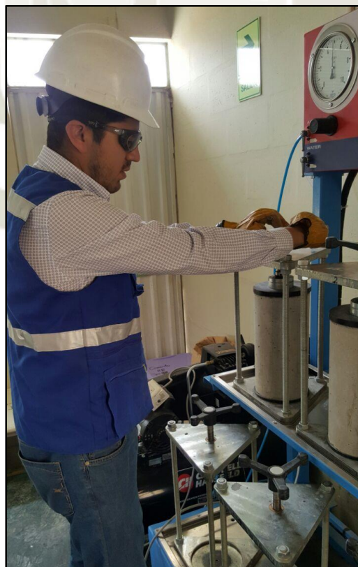
Figura 36. Colocación de probeta en equipo.
