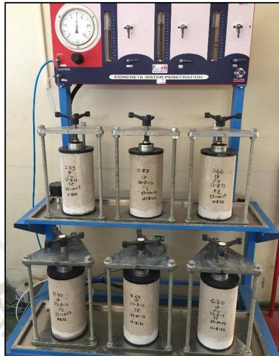
Figura 34. Ensayo de permeabilidad con probetas identificadas.
