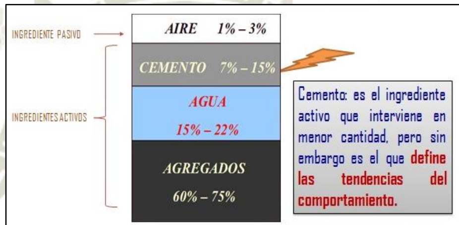
Figura 10. Proporciones típicas en volumen absoluto de los componentes del concreto.
