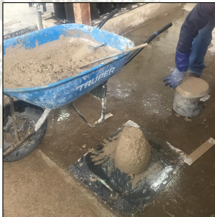
Figura 25. Slump del concreto.
