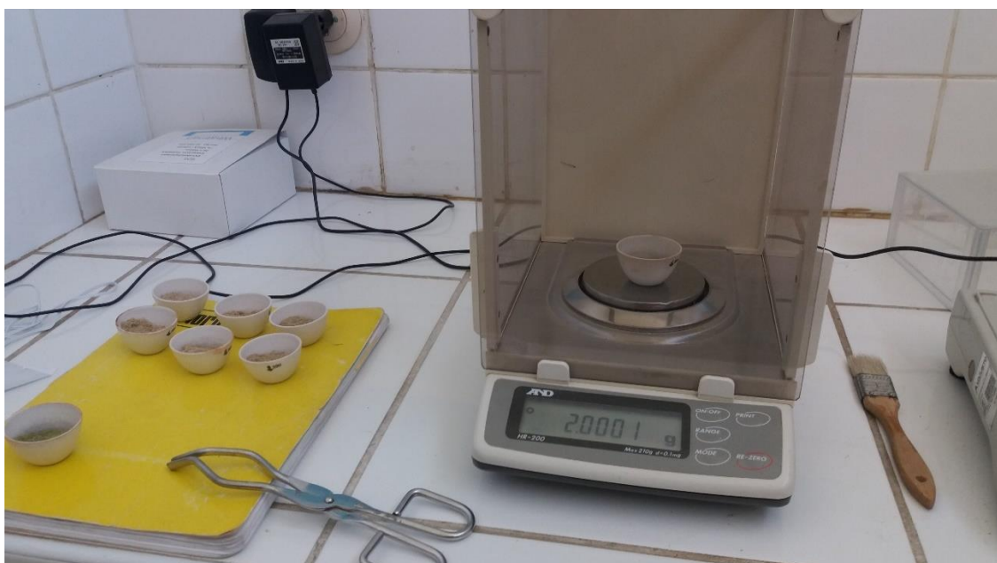
Foto 30. Pesando 2 gramos de muestra de Moringa oleifera para sacar % de materia seca
