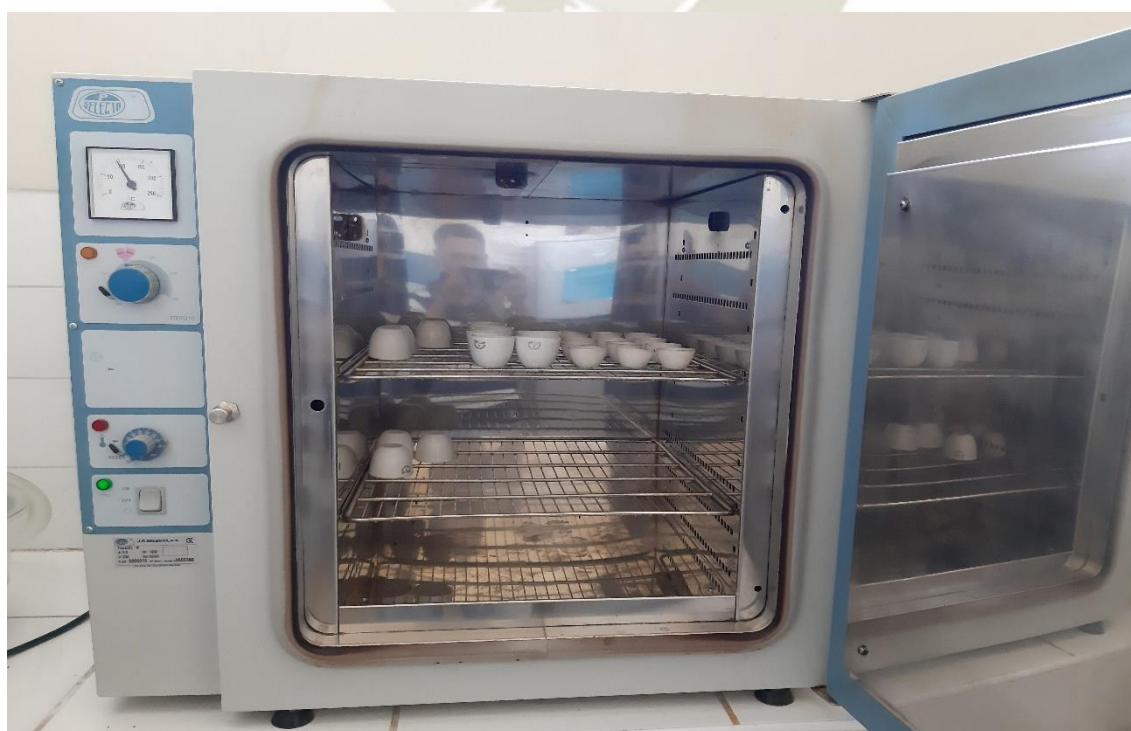
Foto 31. Los crisoles con 2 gramos de muestra en la estufa de convección natural que serán incubada por 2 horas a una temperatura de 102\text{ }^{\circ}\text{C} \pm 5\text{ }^{\circ}\text{C}
