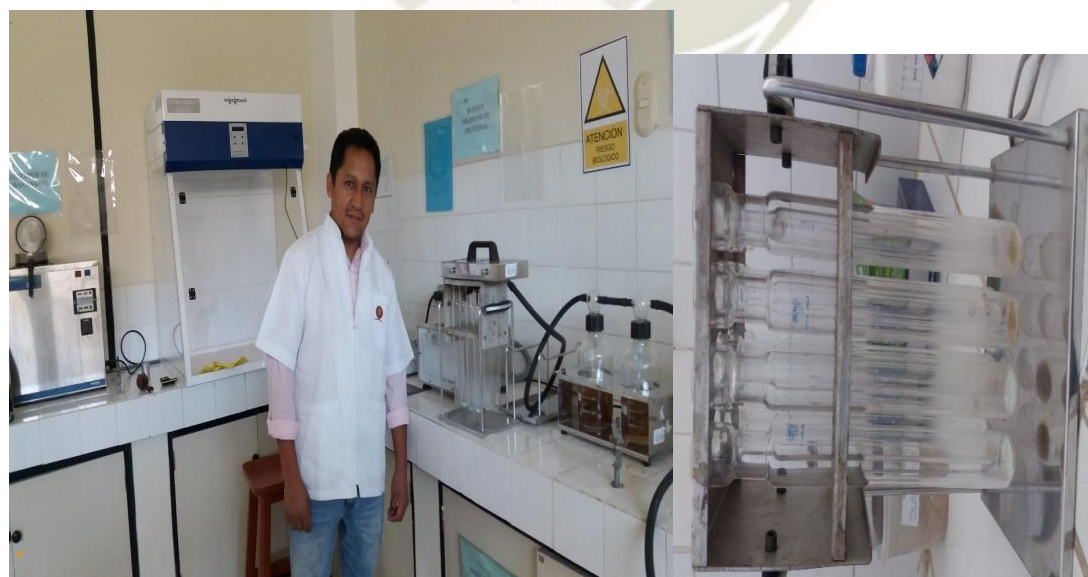
Foto 33. Adicionando 4 ml de ácido sulfúrico a los tubos de Kjendahl, se pone 2 perlas de vidrio, se coloca los tubos en el bloque digestor
