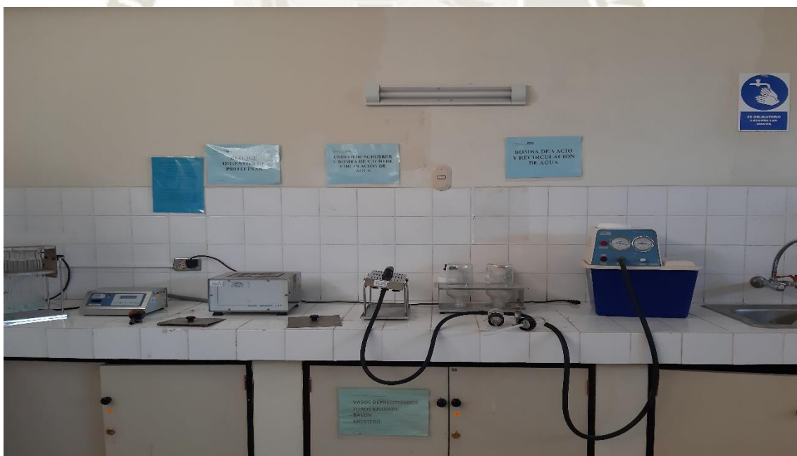
Foto 34. Bloque digestor donde se hace la digestión de proteína a una temperatura de 400 °C por un tiempo de 3 horas y 30 minutos aproximadamente
