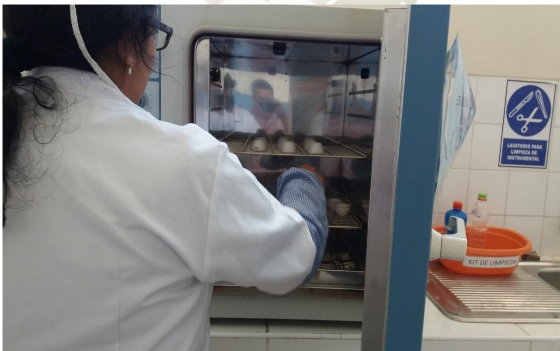
Foto 29. Materia Seca; para sacar materia seca se realiza el siguiente procedimiento se lava los crisoles se coloca a la estufa de convección natural por 1 hora a 100°C ; se coloca al desecador luego se tara el crisol, se pesa la muestra 2 gramos; se lleva a la estufa de convección natural por 2 horas a una temperatura de 102 °C + - 5 °C finalmente se coloca al desecador por 20 minutos y se pesa
