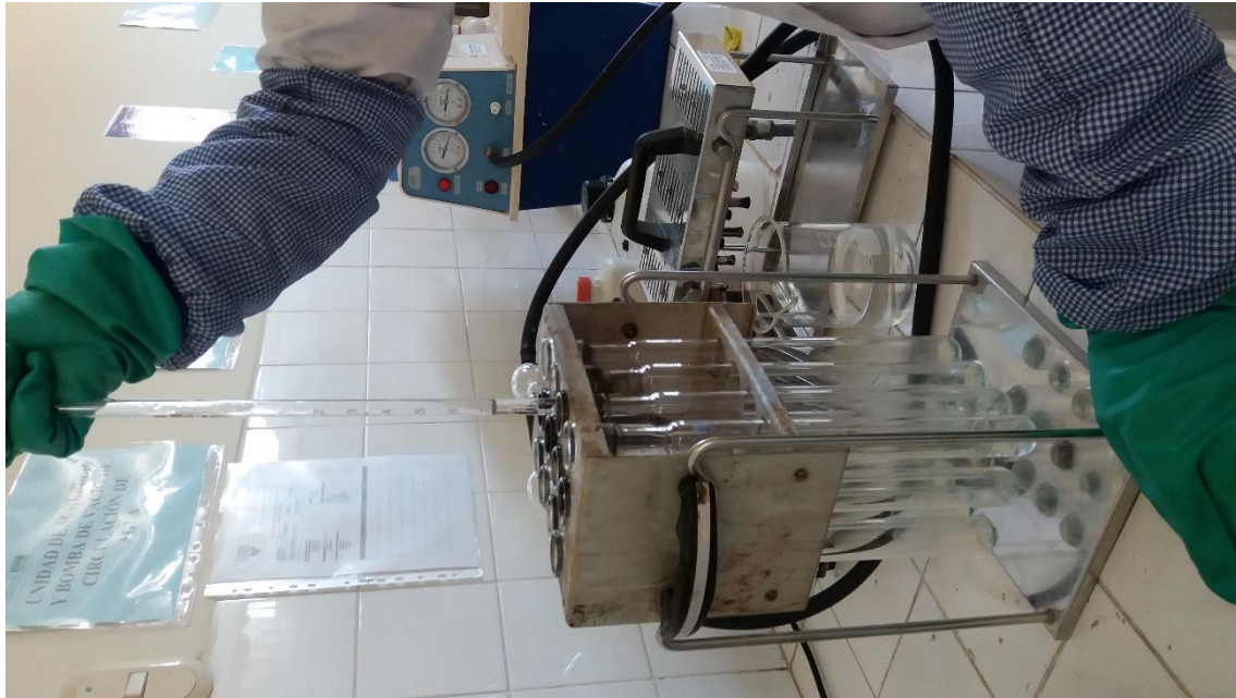
Foto 36. Destilador Kjendahl de Proteina es donde se realiza la destilacion de proteina procedimiento es lo siguiente 1)Los tubos Kjendahl es llevado al destilador 2)Se adicina 25 ml de hidroxido de sodio al 40% a cada tubo 3)Al adicionar se va a teñir de color azul 4)Al otro extremo del equipo se coloca 25 ml de acido borico al 4%en un matraz con3 gotas de indicador mixto 5) se espera por 8 minutos el alarma del equipo obsevando el cambio de color de de morado a turquesa
