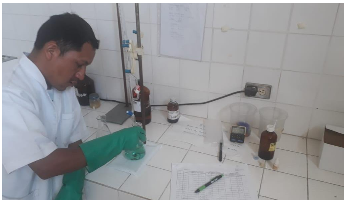
Foto 40. Observando el viraje del color del matraz cambiado de morado a turquesa
