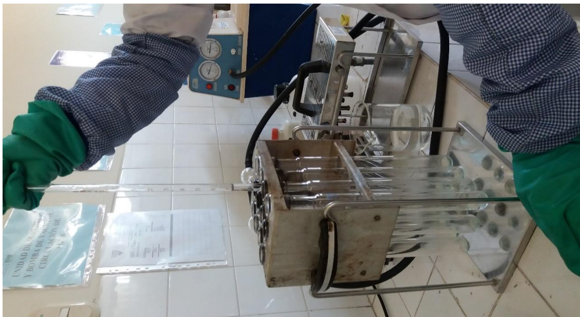
Foto 34. Bloque digestor donde se hace la digestión de proteína a una temperatura de 400 °C por un tiempo de 3 horas y 30 minutos aproximadamente
