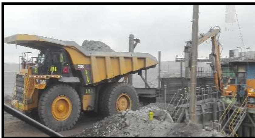
Figura 23. Camión modelo CAT 785C descargando en Planta 1
