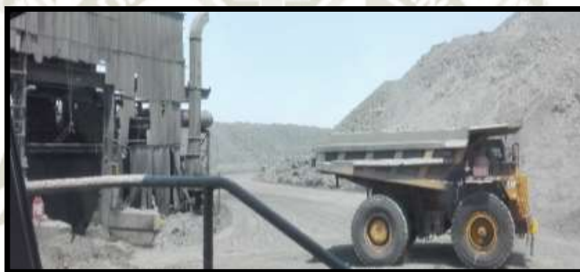
Figura 24. Camión modelo CAT 785C descargando en Planta 2
