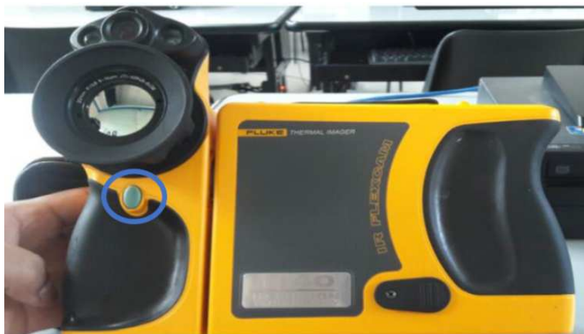
Figura 11: Vera, C. (2017). Cámara Termográfica FLUKE Ti 40. [Fotografía]. Propiedad de Tecsup – Arequipa.
