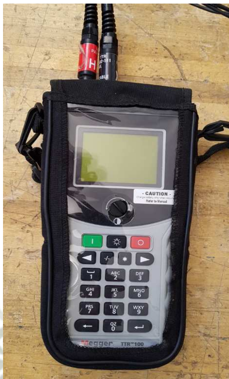
Figura 21: Vera, C. (2017). TTR Digital marca MEGGER TTR100. [Fotografía]. Propiedad de Tecsup – Arequipa.
