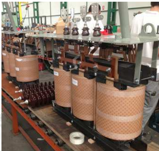
Figura 34: IMEFY GROUP (s.f.). Aislamiento de un Transformador [Fotografía]. Recuperado de http://imefy.com/es/produccion/ España
