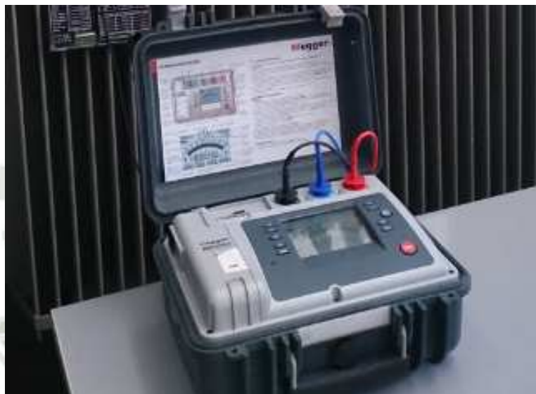
Figura 13: Vera, C. (2017). Megómetro Digital marca MEGGER MIT520. [Fotografía]. Propiedad de Tecsup – Arequipa.
