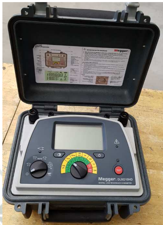
Figura 22: Vera, C. (2017). Equipo Digital marca MEGGER DLRO10HD para Medición de Resistencia de Contactos. [Fotografía]. Propiedad de Tecsup – Arequipa.
