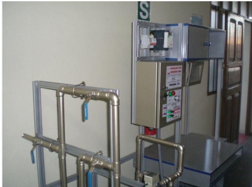
FIGURA No. 114: DETALLE Nro. 1 DEL MÓDULO DIDÁCTICO DE CONTROL DE CAUDAL
